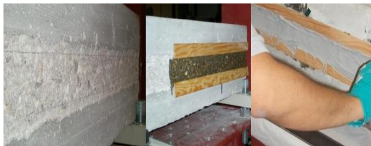
Ilustración 38 Proceso de preparación de los ensayos de adherencia
