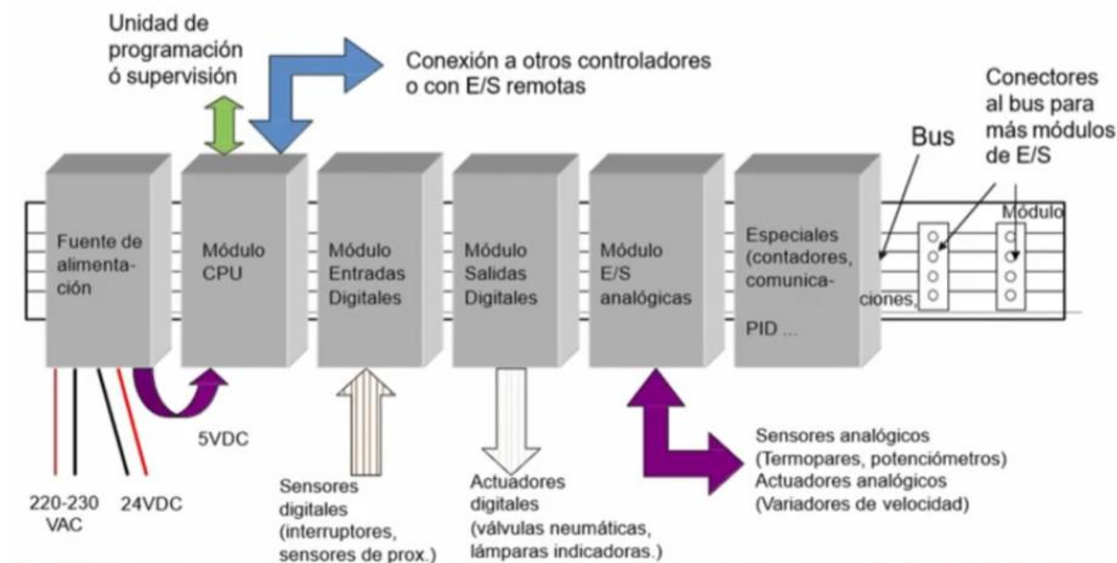
Ilustración 7. Arquitectura Modular de un PLC
