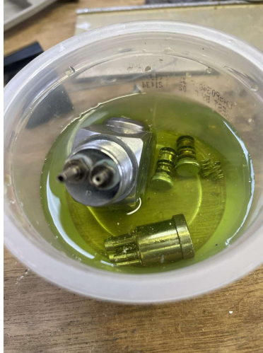
Ilustración 26 Empleando CLR para reconstrucción de jeringa
