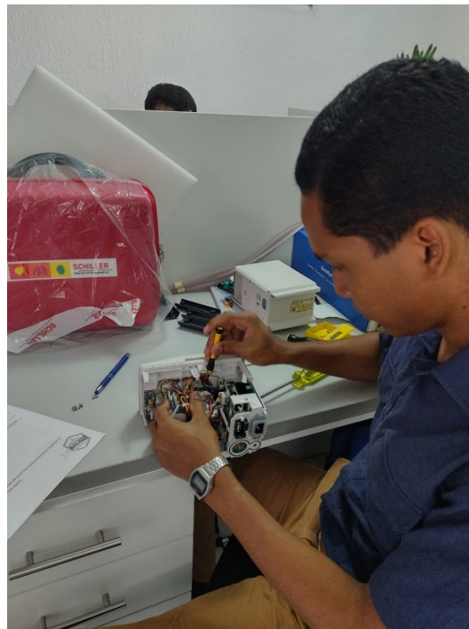
Ilustración 26. Reparación de bomba de infusión marca MedCaptain.
