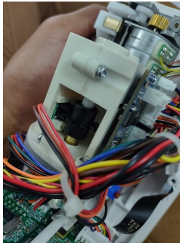
Ilustración 35. Sensor de oclusión y burbuja de aire en Bomba de Infusión Med Captain.
