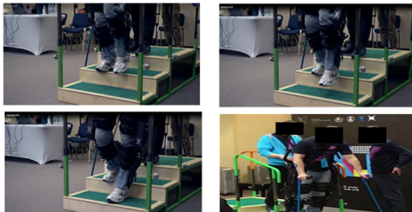
Ilustración 6 A) Primer intento de paso con exoesqueleto. B) Segundo movimiento. C) Paso afianzado usando exoesqueleto. D) Escenario general que incluye terapeuta, paciente, escaleras, pasamanos y muletas.
