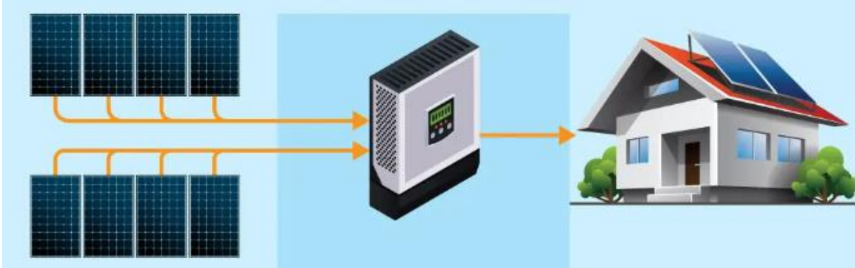
Ilustración 15 – Esquema de un sistema conectado a un inversor de string
