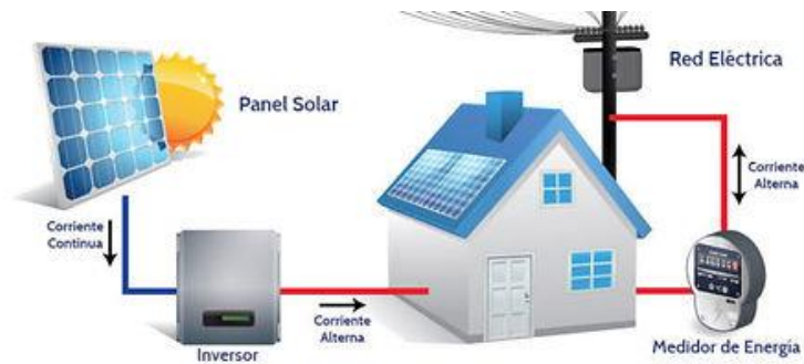
Ilustración 12 - Sistema fotovoltaico de autoconsumo
