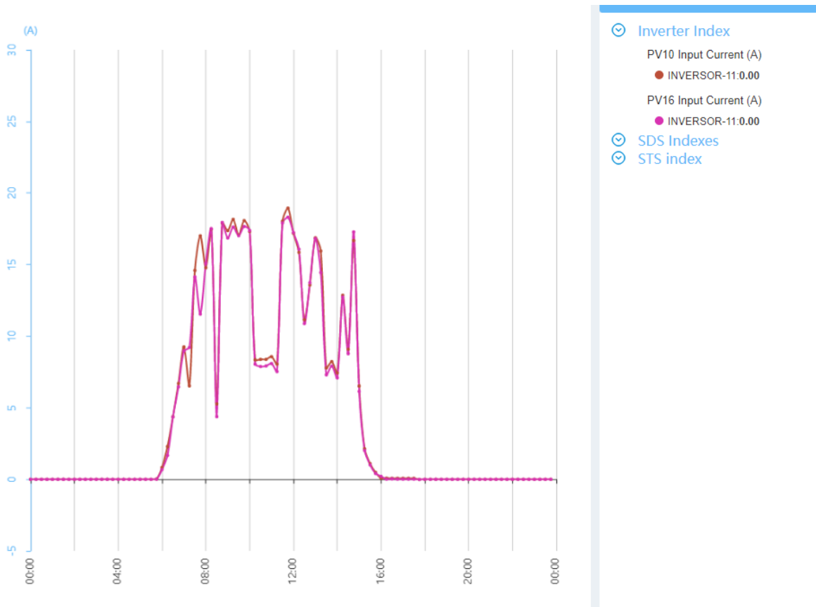
Gráfico 12 - Comparación de amperaje del escenario laminas vs Grama. Fuente: (Sunergy, 2022).
