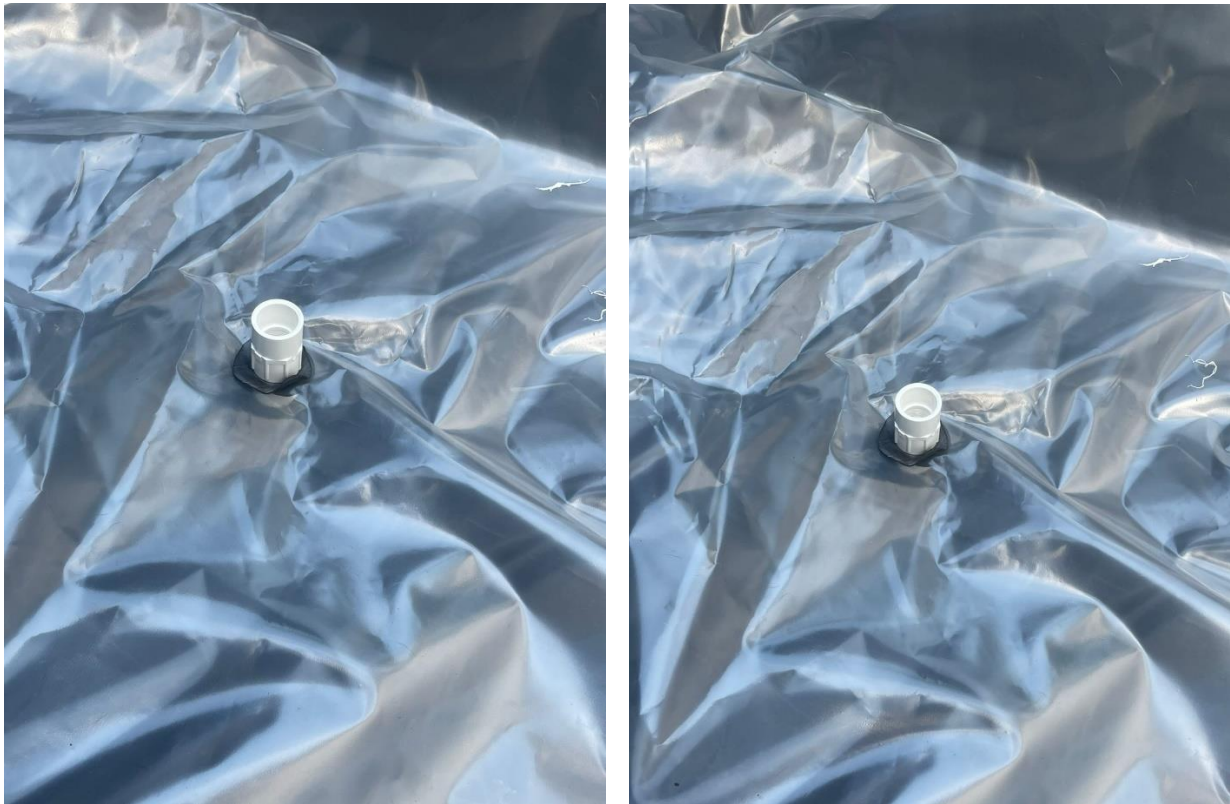
Ilustración 20. Salida para Tubería de Biogás Fuente: Elaboración propia
