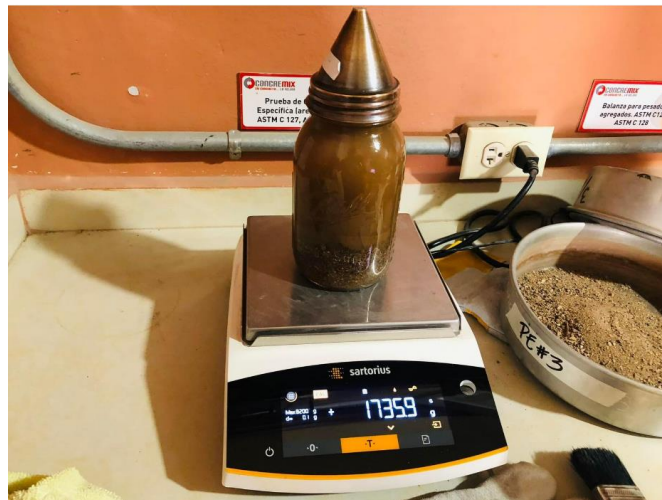
Ilustración 29 - Ensayo de densidad específica del agregado fino.
