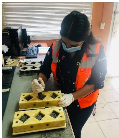
Ilustración 37 - Prueba de especímenes de cemento hidráulico según norma ASTM C109
