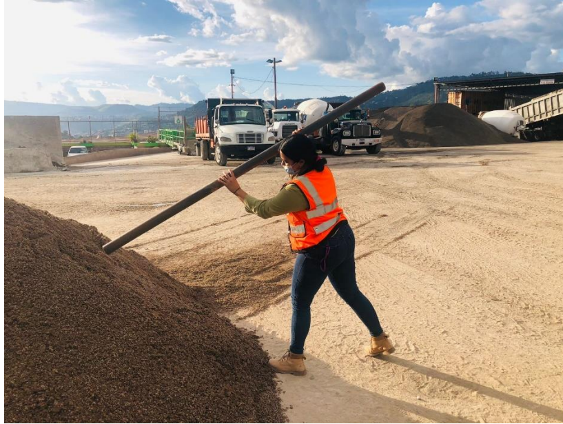
Ilustración 52 - Obtención de la muestra para la arena
