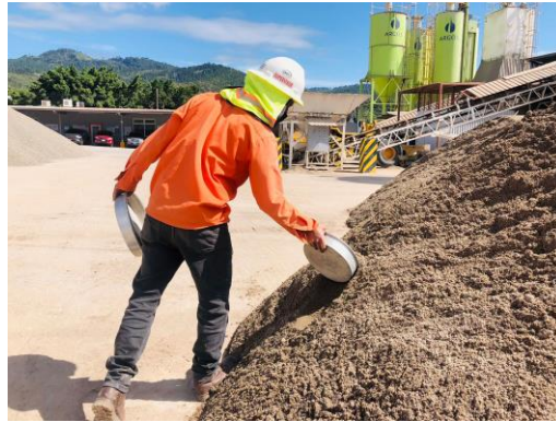
Ilustración 90 - Muestreo de agregados
