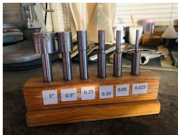
Ilustración 73 - Agujas para ensayo de penetración
