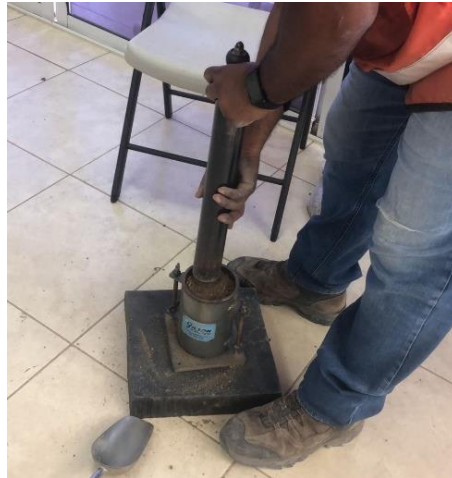
Ilustración 54 - Ensayo Proctor estándar
