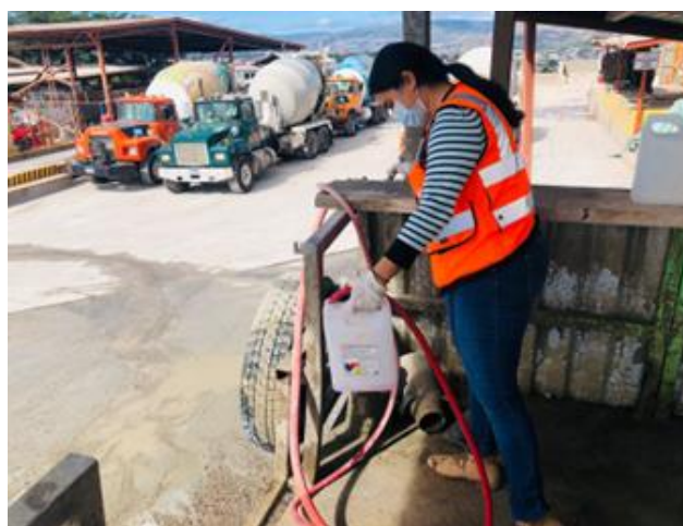
Ilustración 89 - Muestra de agua para análisis
