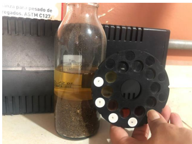
Ilustración 114 - Lectura del ensayo de colorimetría
