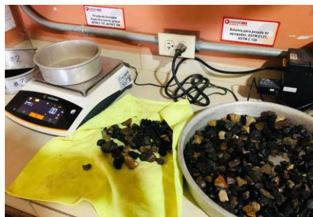
Ilustración 26 - Ensayo de densidad específica del agregado grueso.
