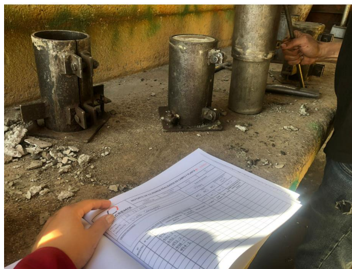
Ilustración 113 - Desmolde de cilindros de diseño de mezcla de concreto
