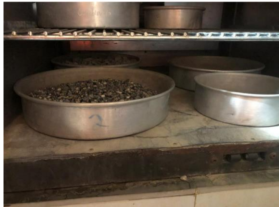
Ilustración 99 - Preparación de muestra para ensayos de granulometría y colorimetría
