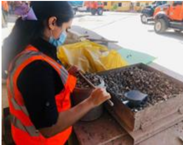
Ilustración 61 - Ensayo de peso unitario del agregado grueso
