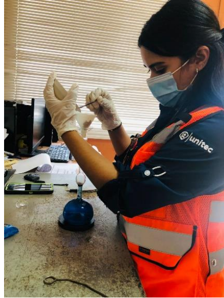
Ilustración 38 - Prueba de densidad del cemento hidráulico según norma ASTM C118
