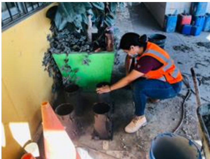
Ilustración 67 - Especímenes de concreto de diseño de mezcla
