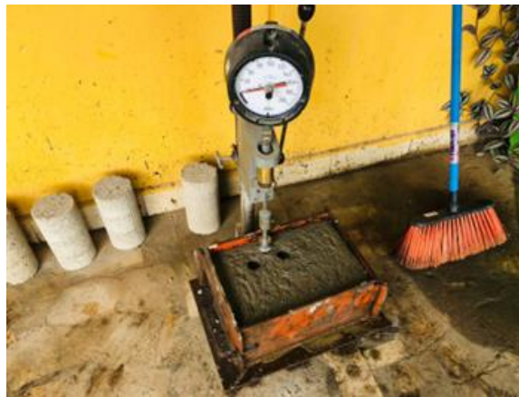
Ilustración 72 - Ensayo de fraguado del concreto
