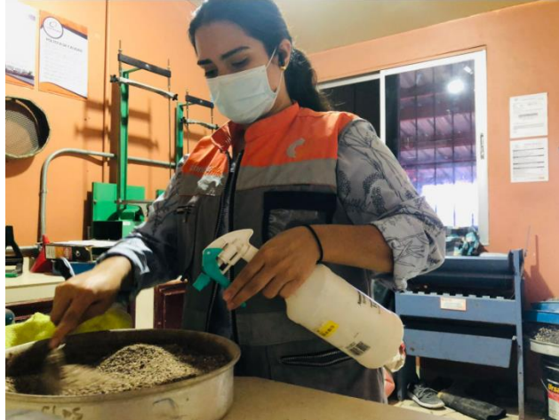
Ilustración 2 - Ensayo de peso específico y absorción para el agregado fino.
