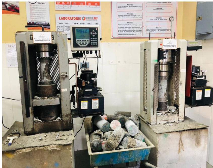
Ilustración 58 - Ensayo de rupturas de cilindros
