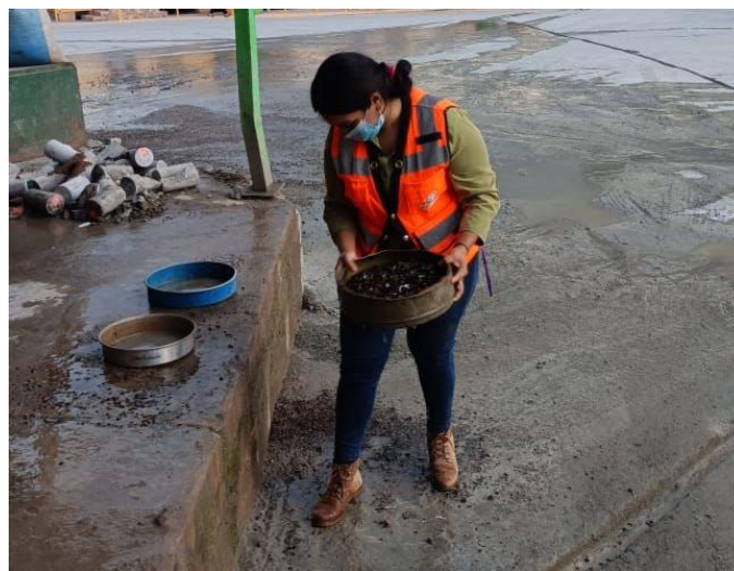
Ilustración 53 - Preparación de muestra para ensayo de agregados
