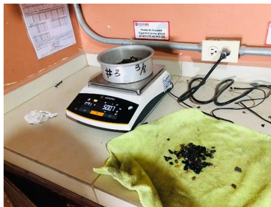
Ilustración 76 – Agregado 3/8 saturado con superficie seca
