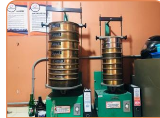
Viernes 11: Ensayo de granulometría de los agregados
