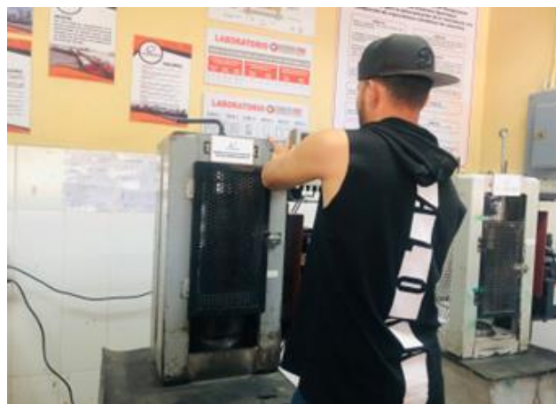
Ilustración 71 - Ensayo de cilindros para cliente
