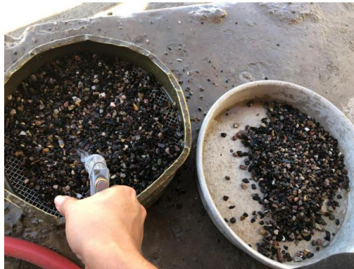
Ilustración 115 - Preparación de muestra de agregado grueso
