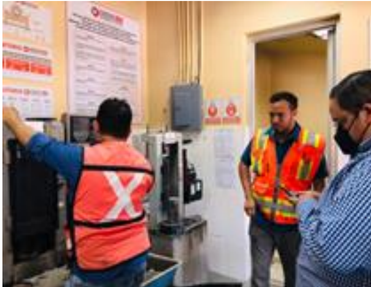
Ilustración 59 - Ensayo de ruptura de cilindros para cliente
