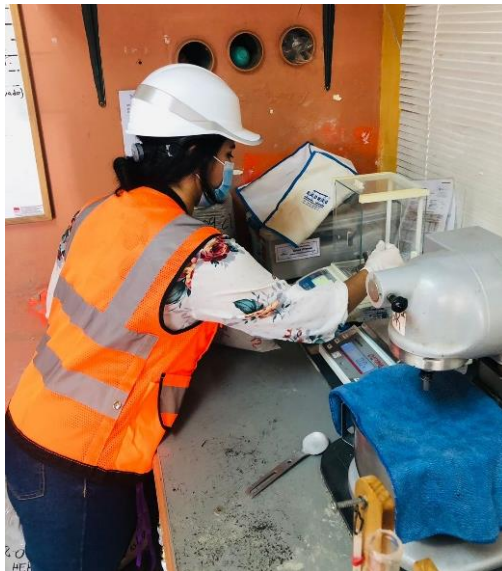
Ilustración 33 - Participación en la prueba de Finura en el laboratorio de Cemento
