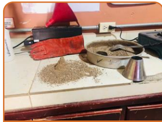
Miércoles 09: Ensayo de peso específico del agregado fino
