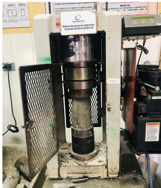
Ilustración 22 - Resistencia a la compresión de cilindros de concreto
