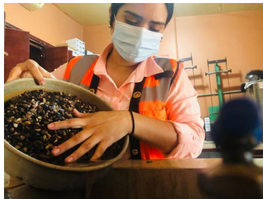
Ilustración 92 - Ensayo Pase 200 mediante lavado
