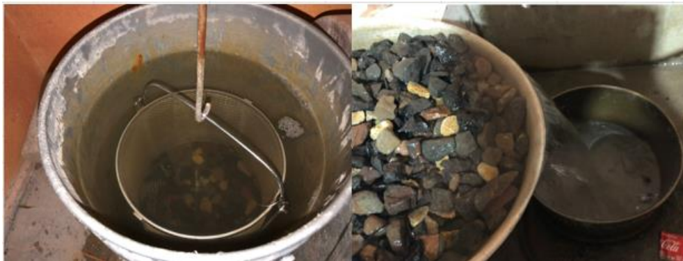
Ilustración 106 - Ensayo de peso específico del agregado grueso y material que pasa la malla No. 200 mediante lavado
