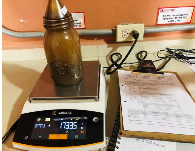
Ilustración 57 - Ensayo para peso específico del agregado fino
