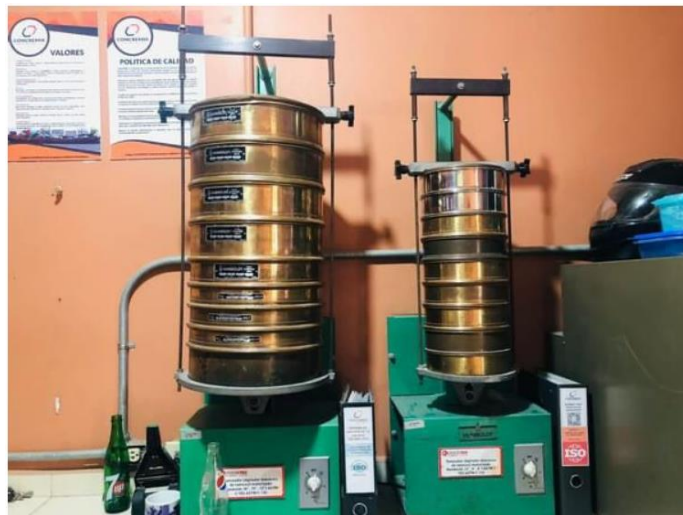
Ilustración 25 - Ensayo de granulometría por mallas para agregado fino y grueso
