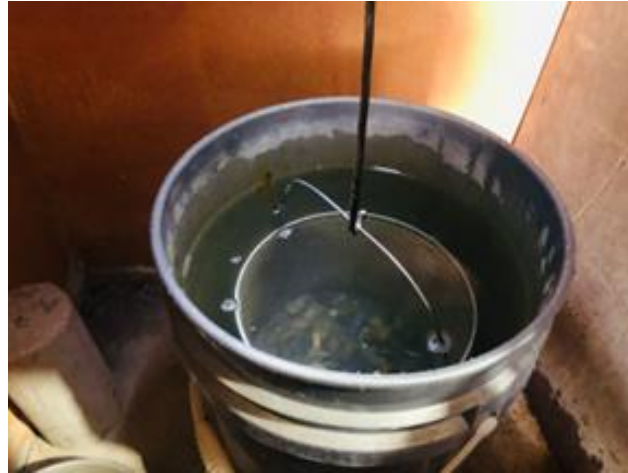
Ilustración 68 - Ensayo de peso específico para agregados gruesos
