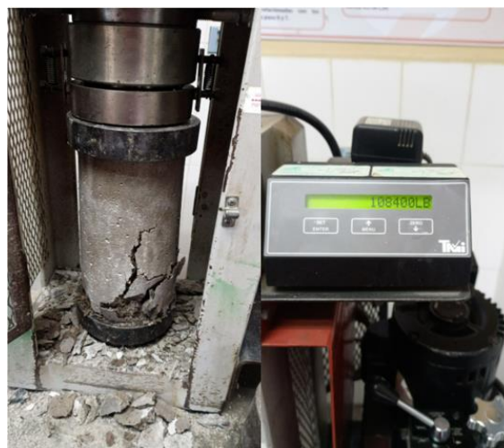
Ilustración 100 - Ensayo de ruptura de cilindros de muestra de diseño de mezcla
