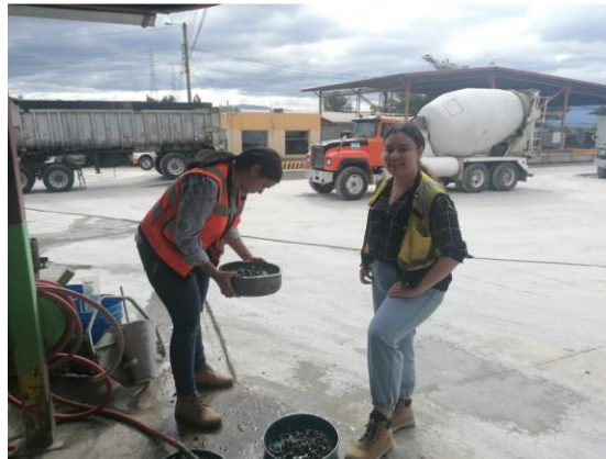
Ilustración 117 - Preparación de muestra de agregado
