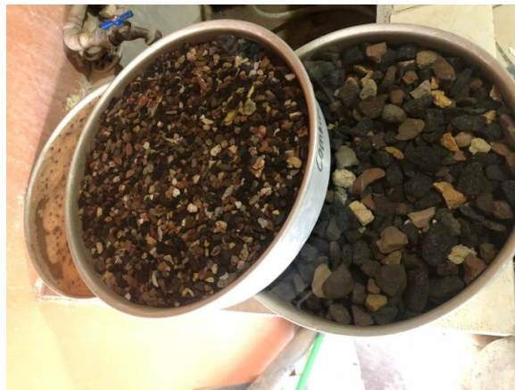
Ilustración 104 - Preparación de muestra de agregados
