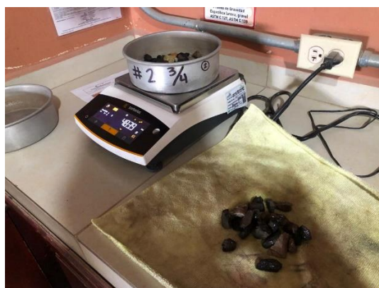
Ilustración 83 - Ensayo de peso específico y absorción
