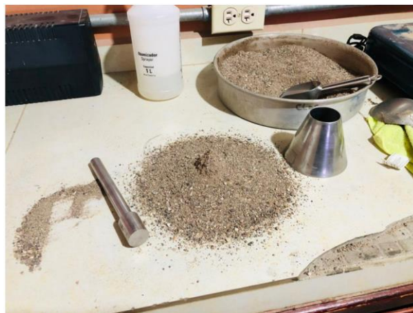
Ilustración 28 - Agregado fino condición saturado superficialmente seco
