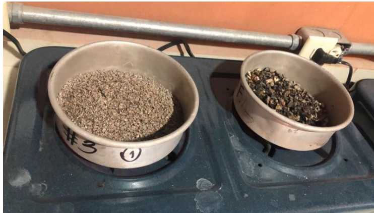
Ilustración 48 - Preparación de muestra para ensayo de humedades.
