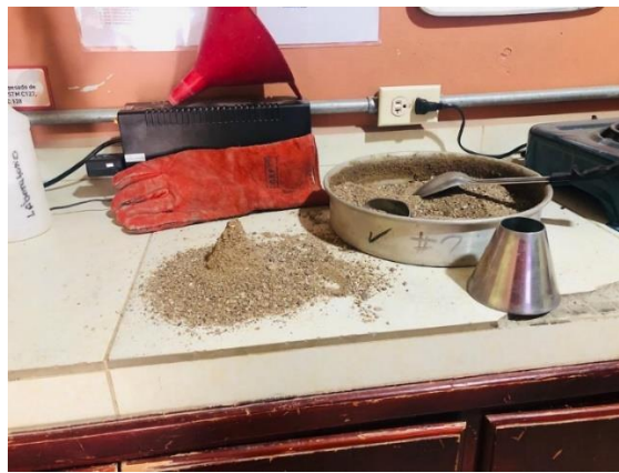
Ilustración 75 - Ensayo para determinar la humedad superficial
