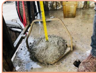
Lunes 14: Ajuste de concreto en planta
