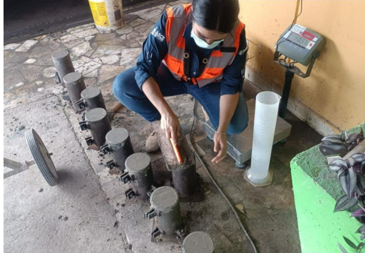
Ilustración 112 - Elaboración de cilindros de concreto
