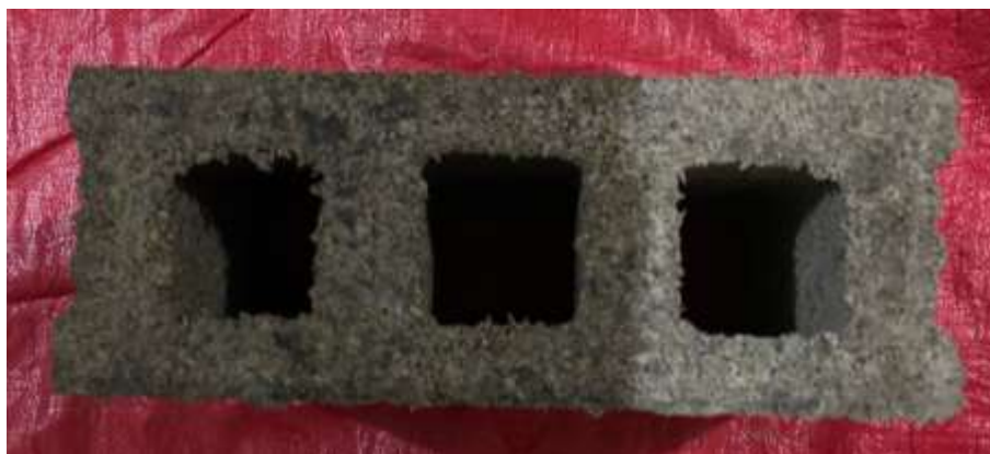
Ilustración 64 Muestra del Escenario 3 después de ser sumergida en el recipiente con agua
