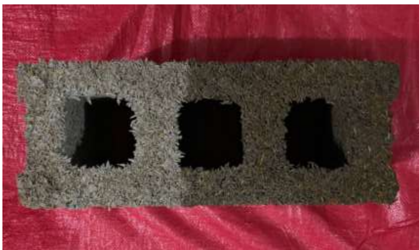
Ilustración 61 Muestra del Escenario 2 después de ser sumergida en el recipiente con agua
