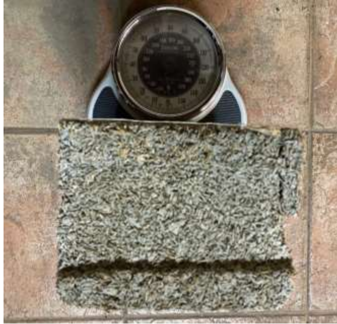
Ilustración 48 Peso previo a la prueba de humedad en el escenario 1
