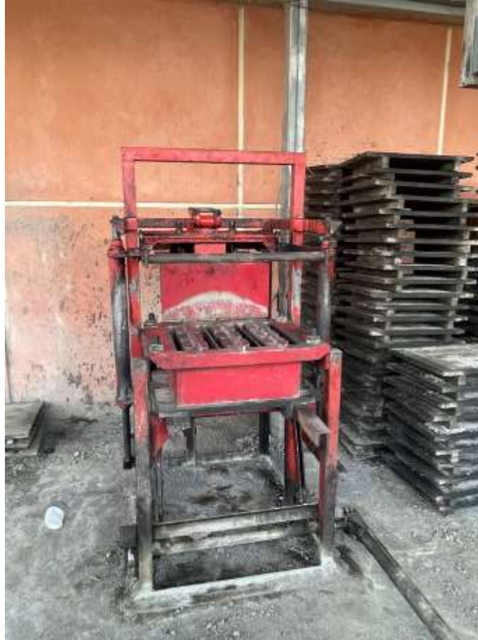
Ilustración 19 Maquina Manual Vibro compactadora de Bloques
