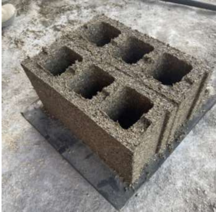
Ilustración 30 Bloques elaborados con mayor cantidad cáscara de arroz en la mezcla
