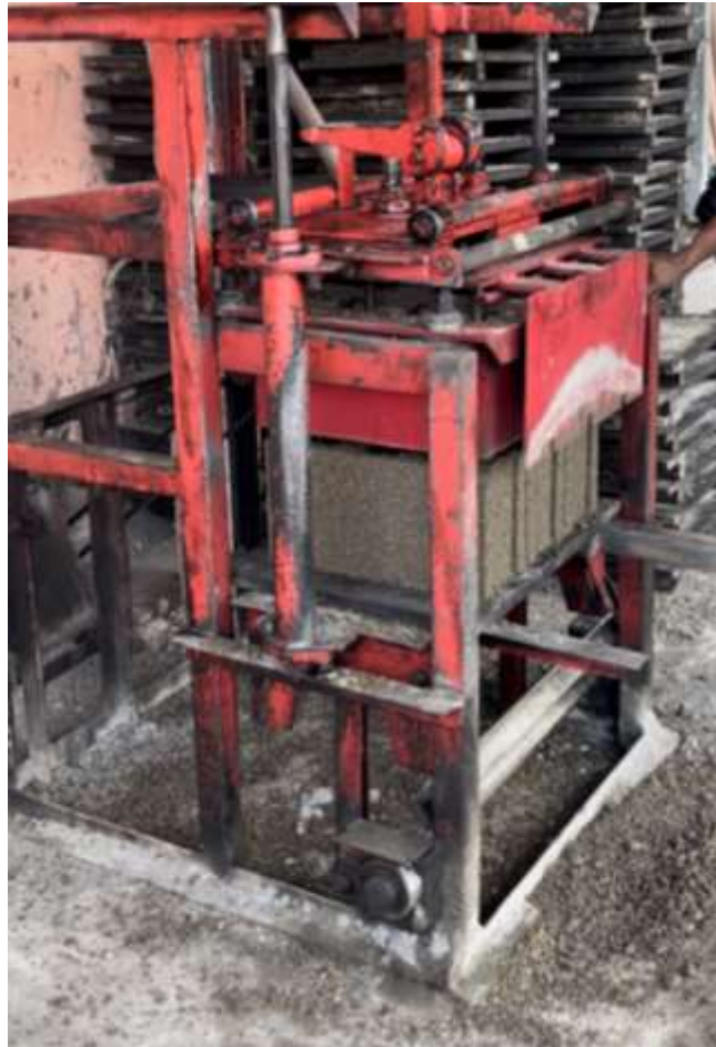
Ilustración 29 Máquina Manual Vibrocompactadora de Bloques
