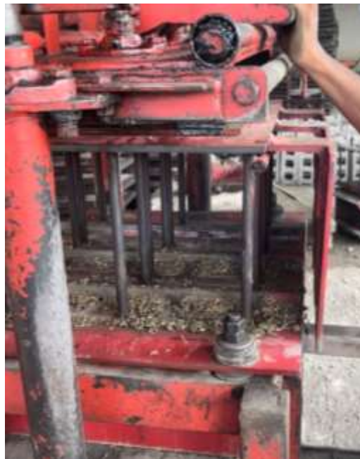
Ilustración 28 Compactación de la mezcla en los bloques
