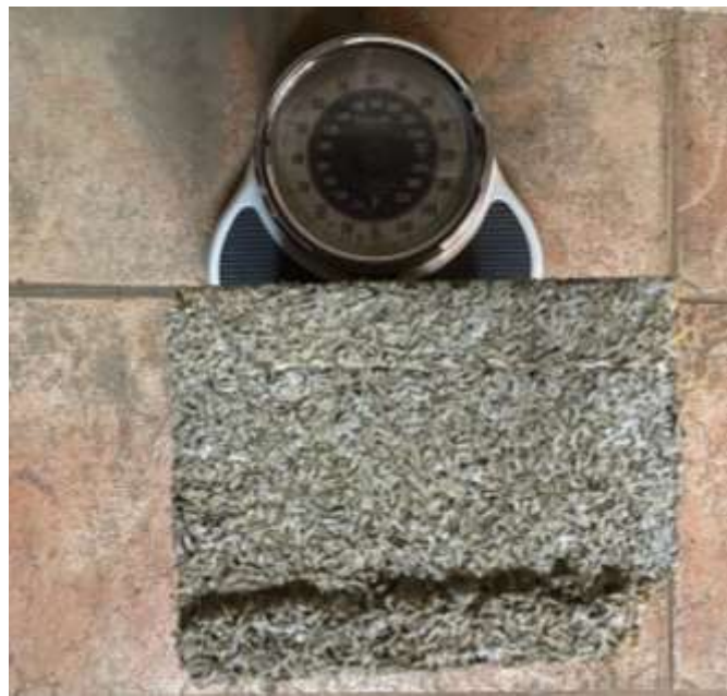
Ilustración 49 Peso previo a la prueba de humedad en el escenario 2
