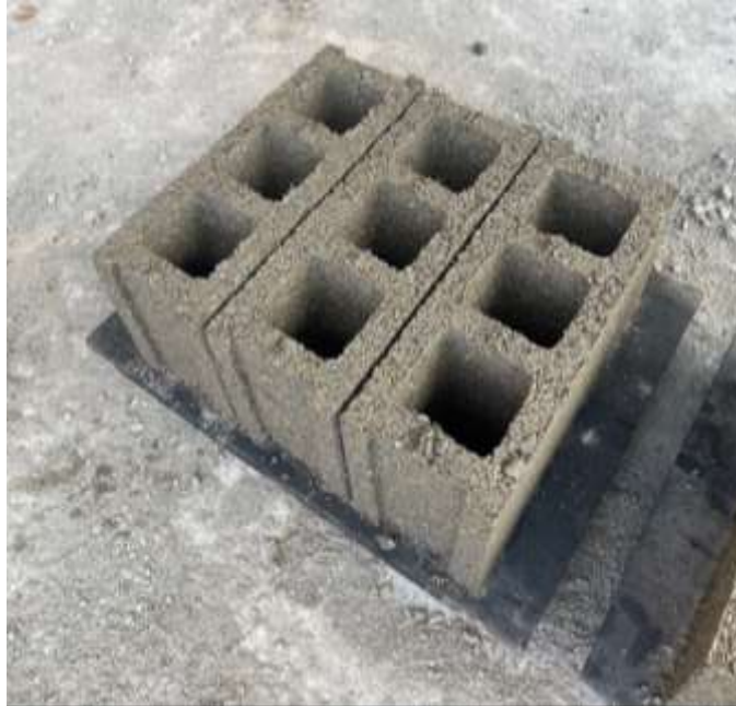
Ilustración 32 Bloques elaborados con menor cantidad de cáscara de arroz
