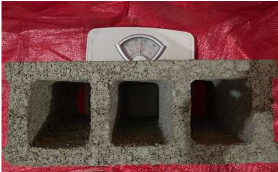
Ilustración 38 Medición del peso del bloque del Escenario 3
