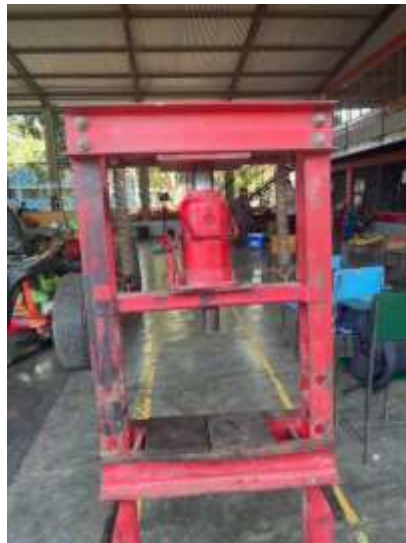
Ilustración 8 Prensa Hidráulica Manual
