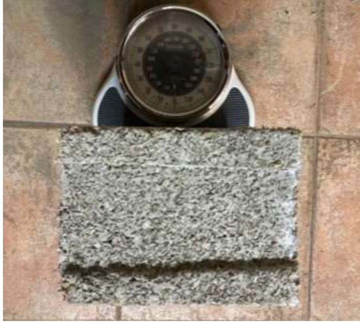
Ilustración 50 Peso previo a la prueba de humedad en el escenario 3
