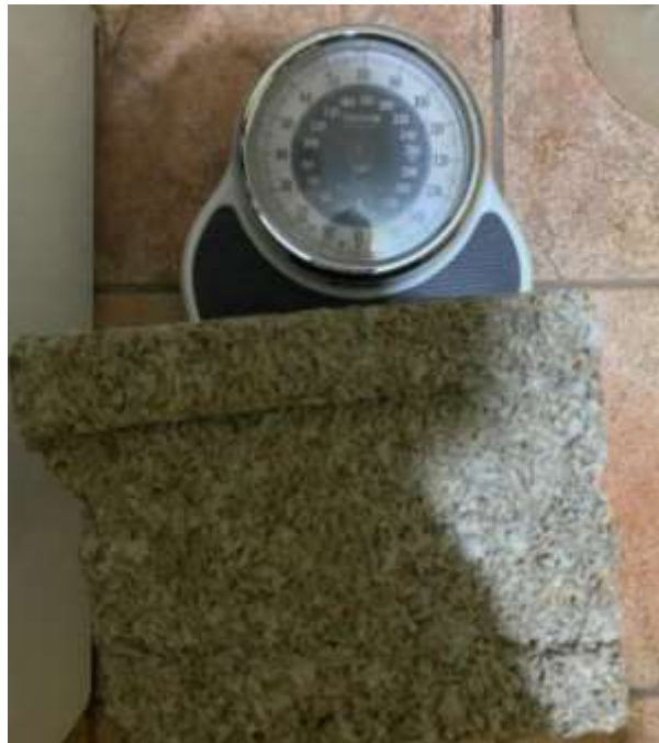
Ilustración 55 Peso después de la prueba de humedad en el escenario 3
