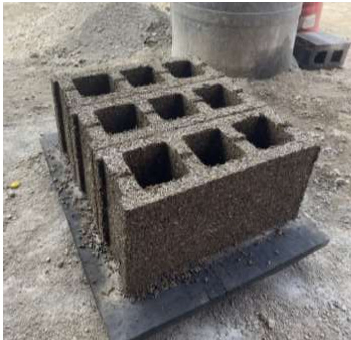
Ilustración 31 Bloques elaborados con igual cantidad de cemento y cáscara de arroz
