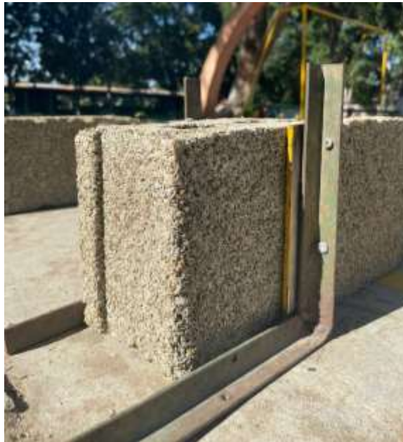
Ilustración 43 Método de placa caliente en Escenario 3
