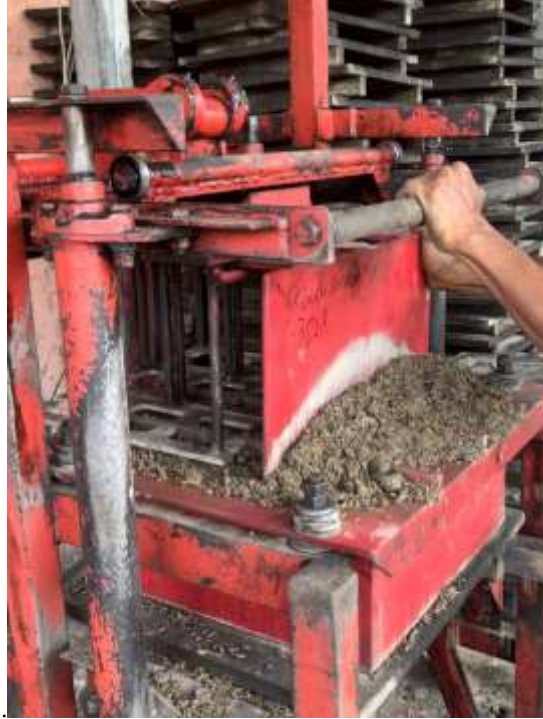
Ilustración 27 Retiración de exceso de mezcla de la maquina
