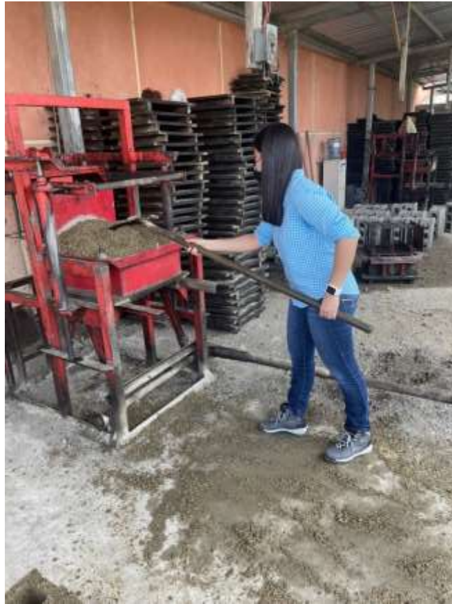
Ilustración 26 Introducción de la mezcla en la prensa hidráulica
