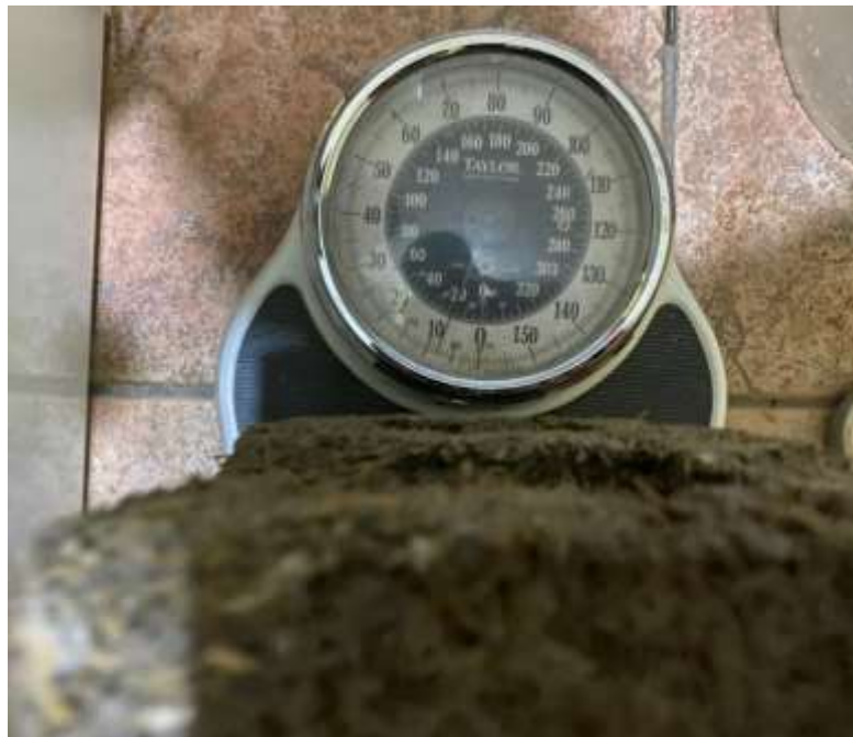
Ilustración 53 Peso después de la prueba de humedad en el escenario 1
