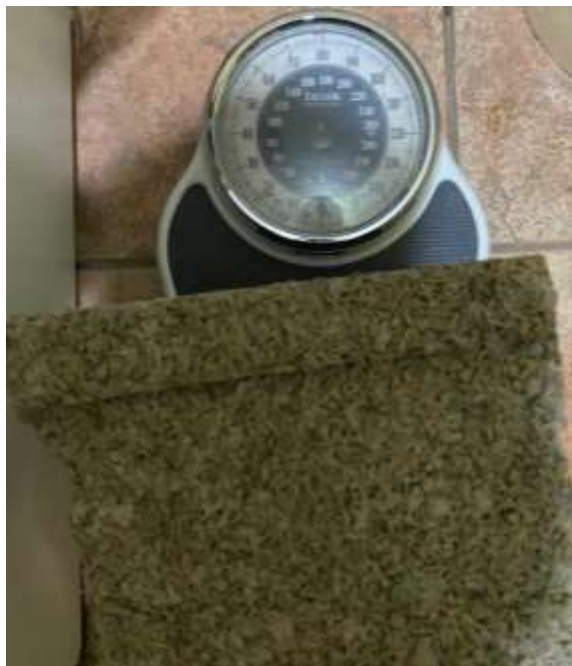
Ilustración 54 Peso después de la prueba de humedad en el escenario 2
