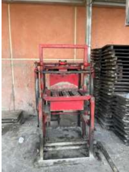
Ilustración 7 Máquina Manual Vibro compactadora de Bloques
