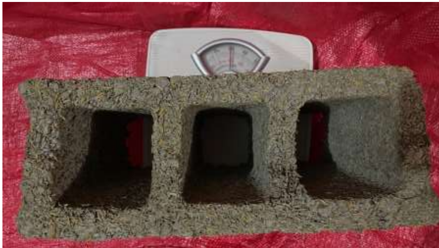
Ilustración 34 Medición del peso del bloque del Escenario 1
