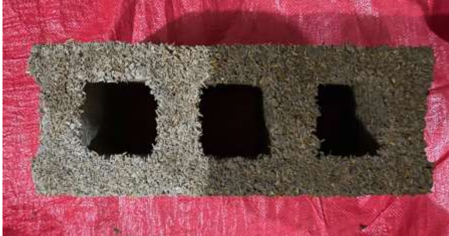
Ilustración 58 Muestra del Escenario 1 después de ser sumergida en el recipiente con agua
