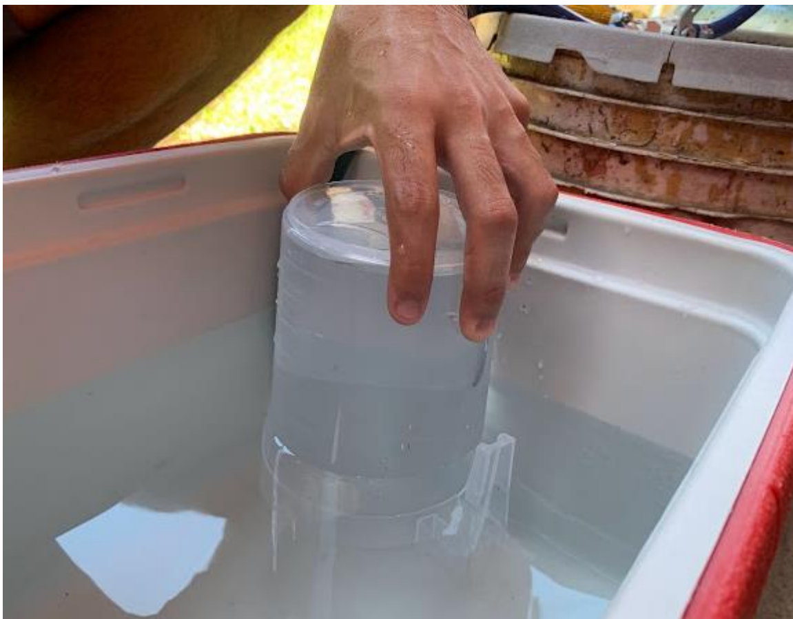
Ilustración 42 Método de desplazamiento de agua
