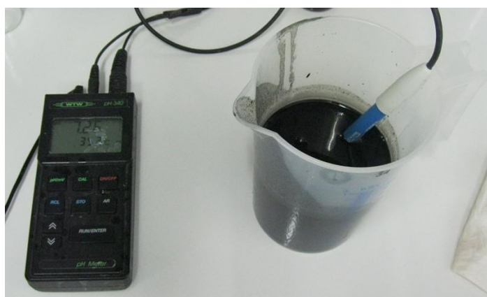
Ilustración 36 Medición de pH de POME
