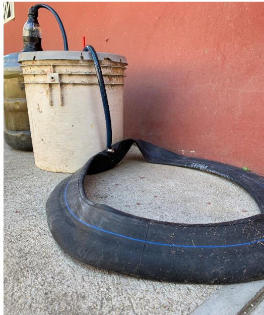
Ilustración 53 Sistema de almacenamiento de biogás en semana 3 del proyecto
