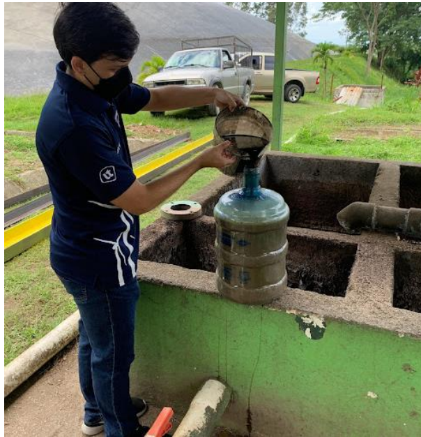
Ilustración 35 Vertimiento de POME digerido en compartimiento para biodigestor
