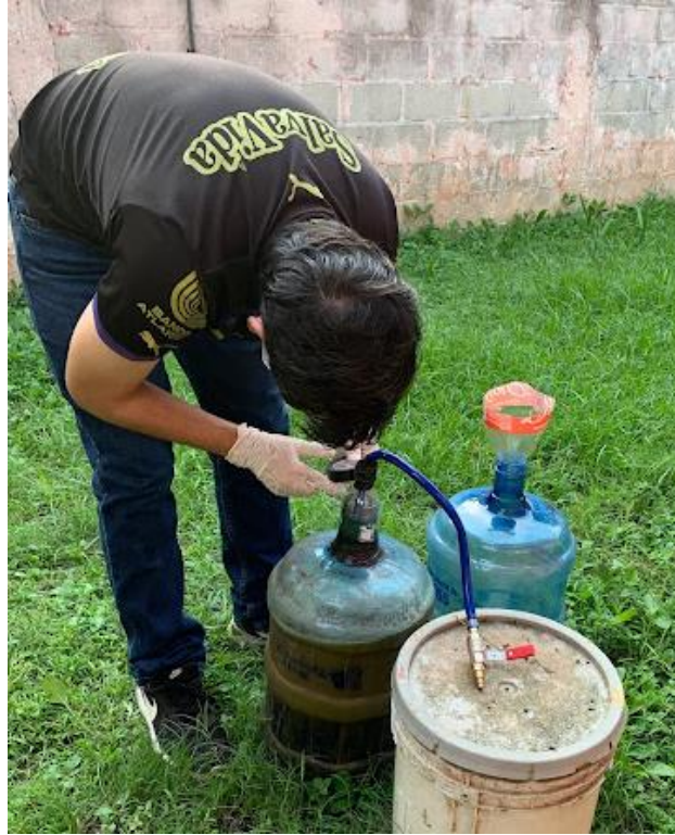
Ilustración 26 Sellamiento de biodigestor
