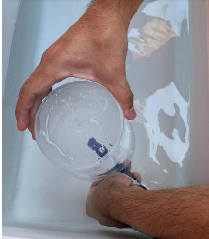
Ilustración 43 Medición de producción de biogás
