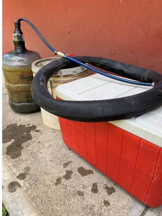
Ilustración 54 Sistema de almacenamiento de biogás en semana 6 del proyecto
