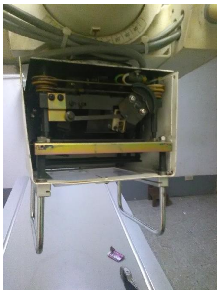
Ilustración 56. Reemplazo de luz halógena en máquina de rayos X
