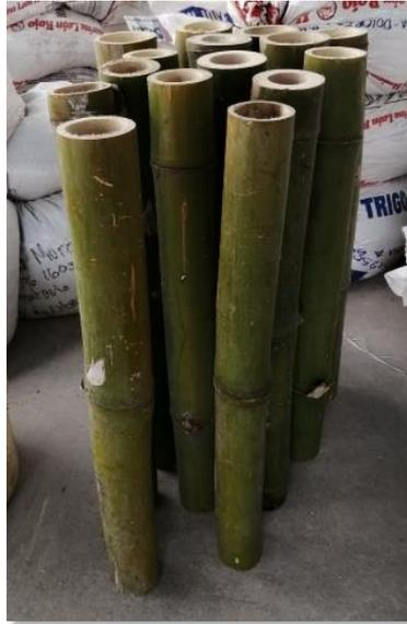
**Ilustración 59. Muestras de bambú para ensayo a flexión**
