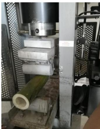
**Ilustración 61. Ensayo a flexión del bambú**
