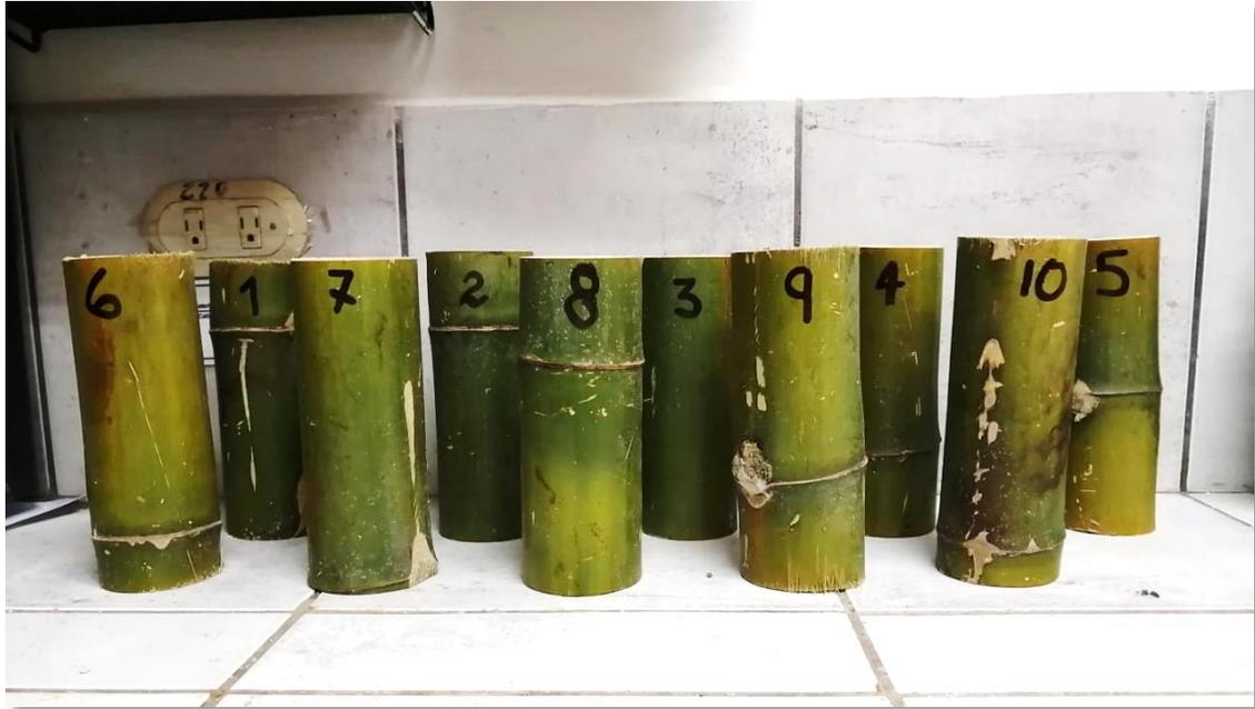
**Ilustración 52. Muestras de bambú para ensayo a compresión**
