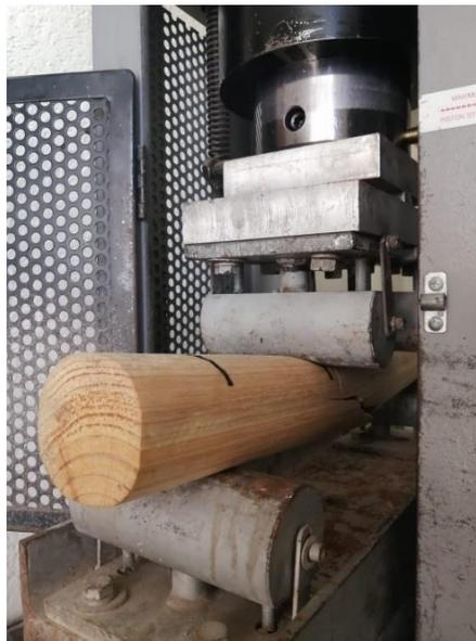
**Ilustración 70. Ensayo de resistencia a la flexión de la madera**
