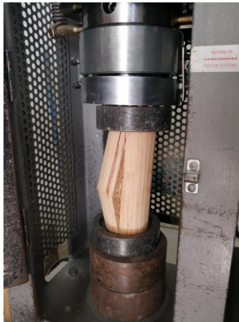
**Ilustración 68. Ensayo de resistencia a la compresión (madera)**
