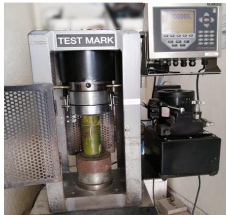
**Ilustración 55. Ensayo a compresión del bambú**
