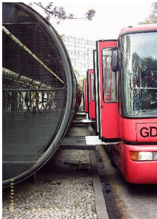
**Ilustración 93. Plataforma Elevada en Parada de Buses, Curitiba**
