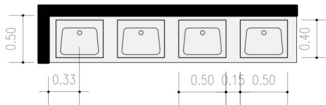
Ilustración 24: Dimensiones para lavamanos en servicios sanitarios
