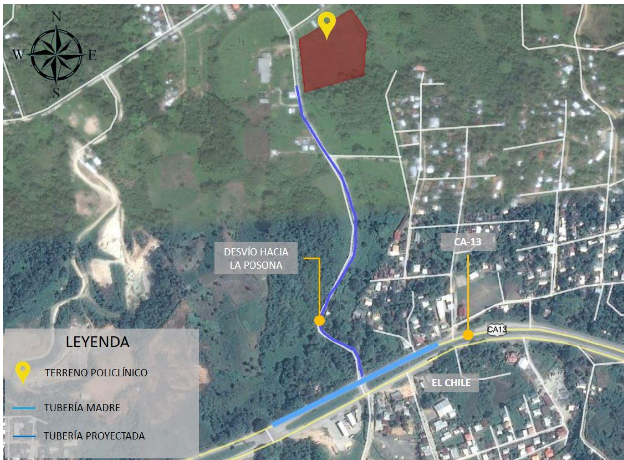
Ilustración 59. Ubicación de tubería madre de agua potable.
