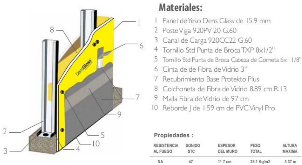
ilustración 42- Diagrama de Tablayeso para Exterior fuente: panelrey.com
