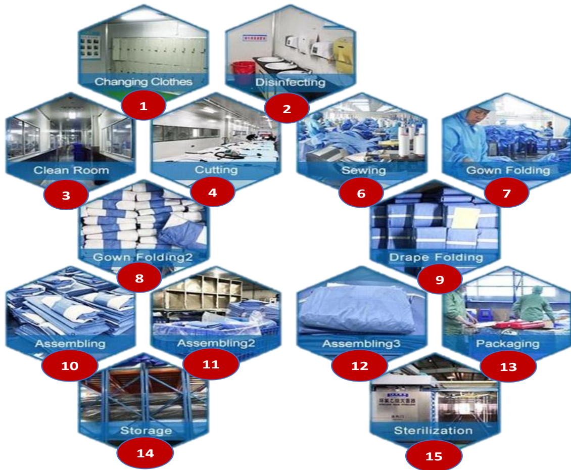
Figura 3. Proceso de Fabricación de Batas
