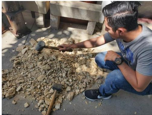
**Ilustración 108- Preparación de muestra para ensayo CBR.**
