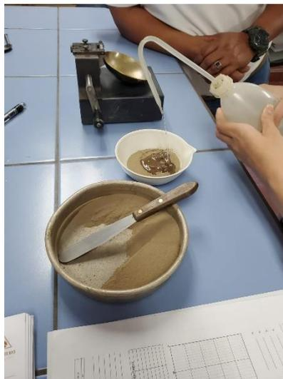
**Ilustración 109- Muestra para ensayo Límites de Atterberg.**
