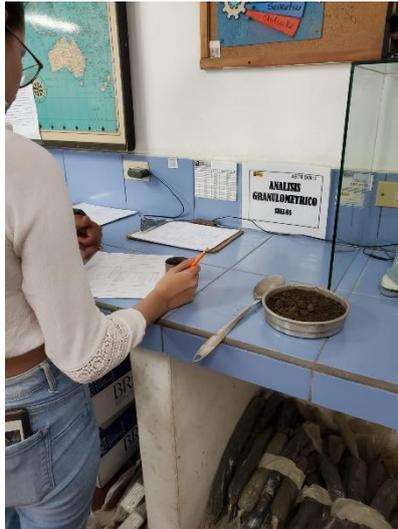
**Ilustración 110- Muestra para ensayo de Granulometría.**
