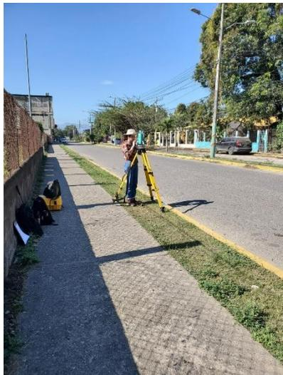
**Ilustración 101- Levantamiento Topográfico.**
