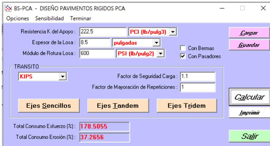
**Ilustración 93-Iteración con espesor de 8.5 pulgadas**
