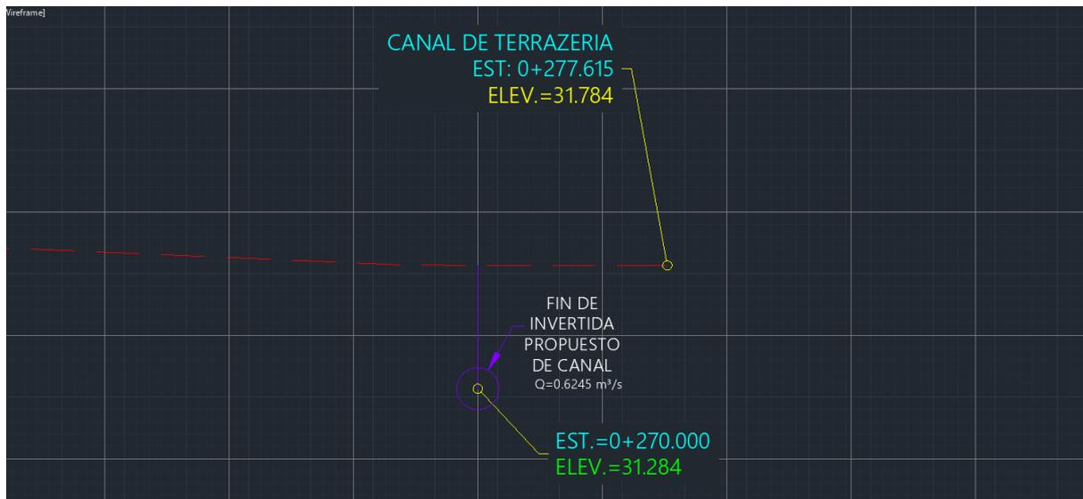
**Ilustración 50- Nivel de Invertida de Salida de Cuneta**
