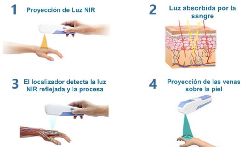
Ilustración 2 - Funcionamiento estándar de dispositivo localizador de venas bajo el principio de luz reflectiva.
