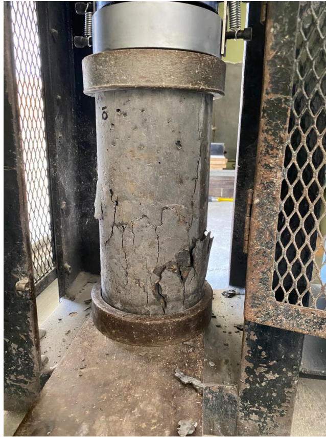
Anexo 11 - Ruptura de cilindro con 15% de CV
