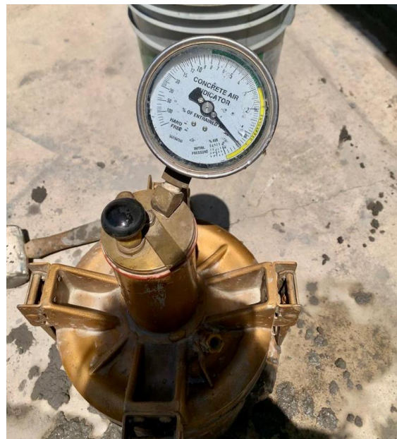
Ilustración 42 -Contenido de Aire
