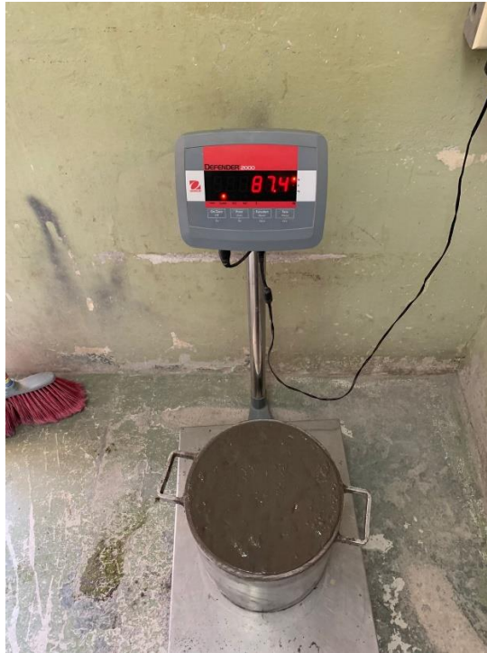
Anexo 5 – Peso de concreto en estado fresco
