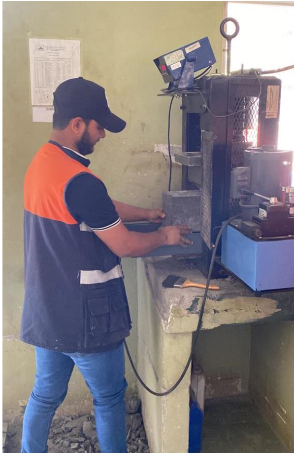
Anexo 9 - Pruebas de resistencias en máquina de compresión y flexión
