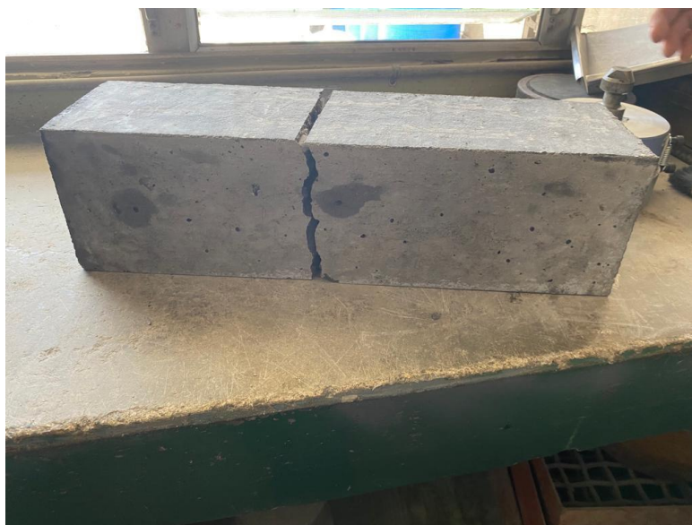
Anexo 10 - Ruptura de viga con 15% de CV
