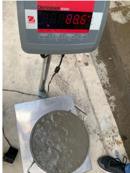
Ilustración 41 - Peso de Concreto estado plástico
