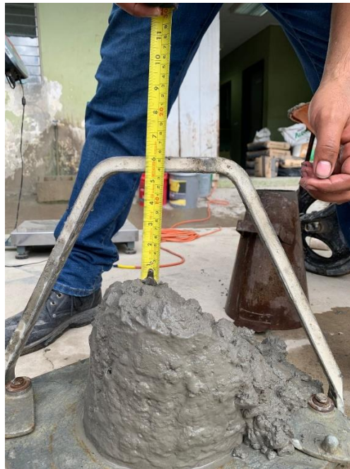
Anexo 4 - Prueba de revenimiento 6.25'' con 15% de CV
