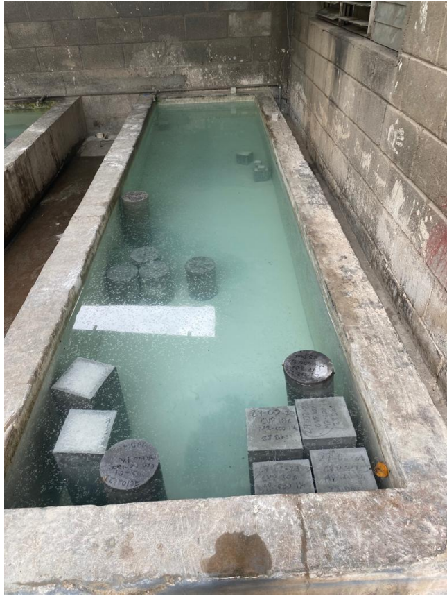
Anexo 7 - Pila de curado
