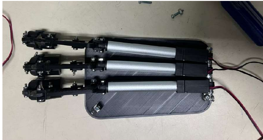
Ilustración 71. Proceso montaje placa actuadores.
