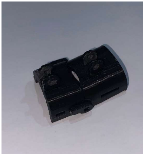
Ilustración 68. Ensamble partes falange media y proximal.
