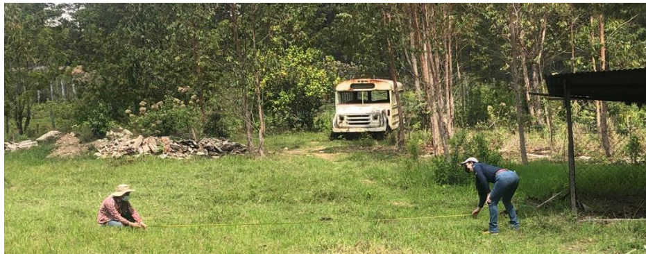
Ilustración 29 Uso de cinta métrica para medición del terreno
