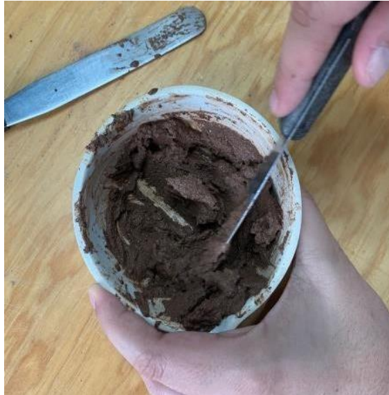
Ilustración 40 Haciendo la pasta de suelo y agua destilada
