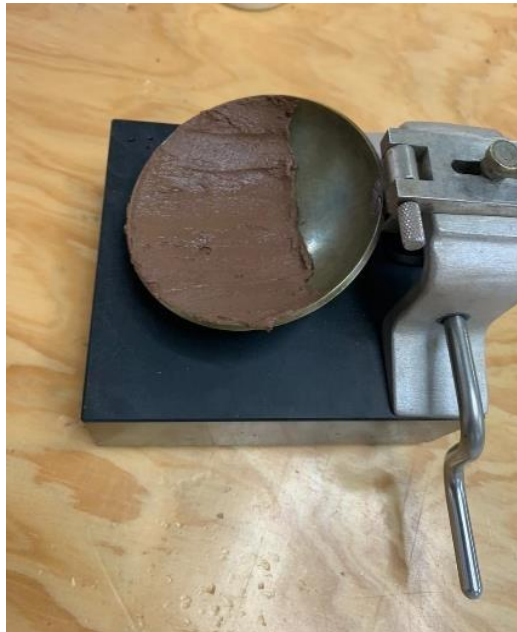
Ilustración 41 Llenado horizontal de la copa
