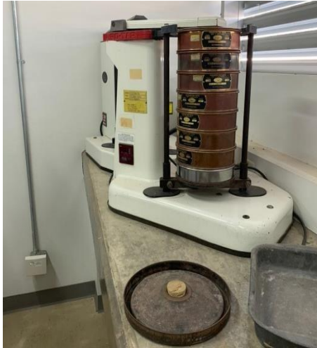
Ilustración 36 Torre de tamices en máquina tamizadora
