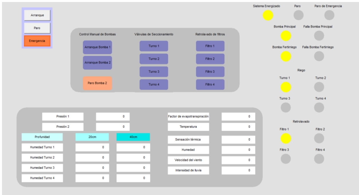
Ilustración 46. Apertura de electroválvula para retrolavado filtro 1
