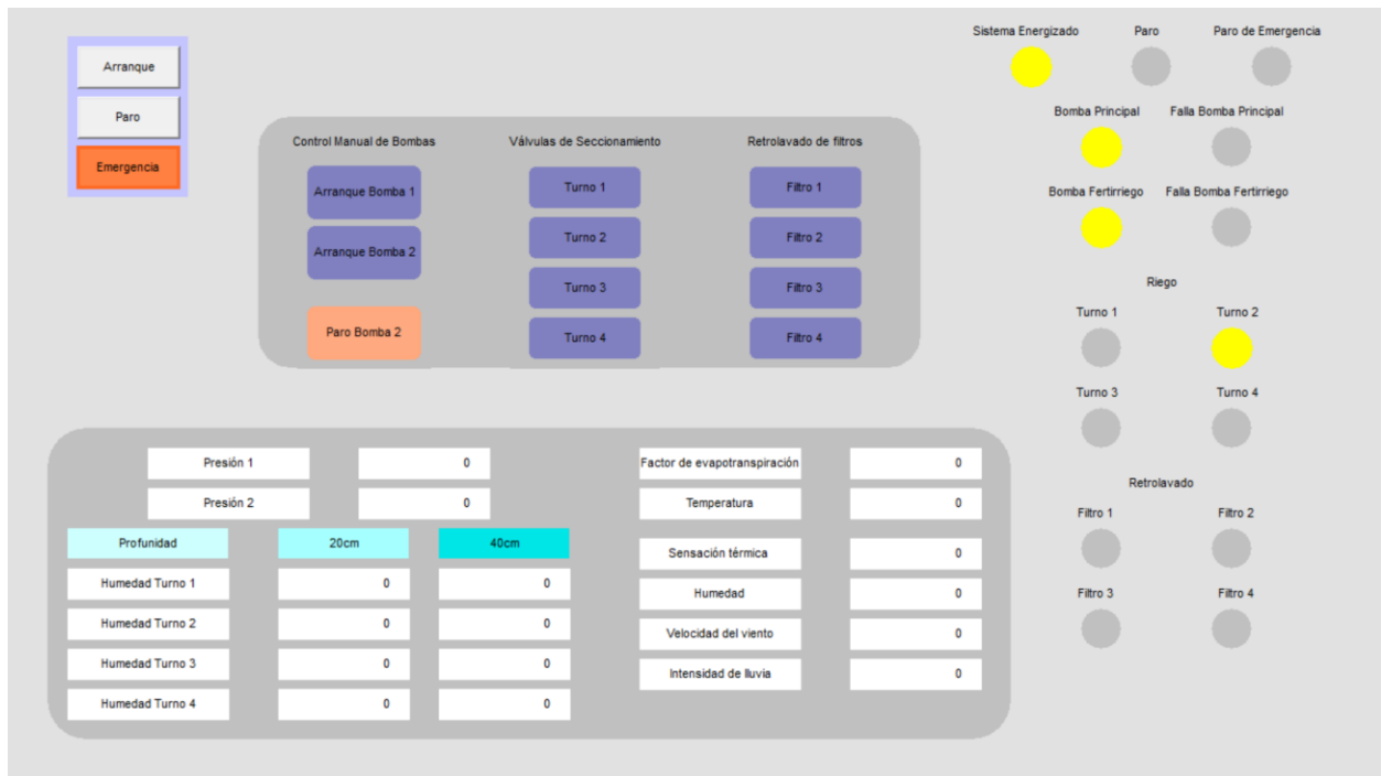
Ilustración 43. Apertura de electroválvula turno 2
