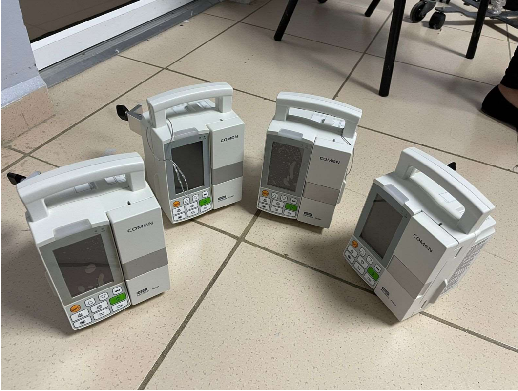
Ilustración 25. Mantenimiento correctivo de bombas de infusión terminado. Fuente: Elaboración Propia.
