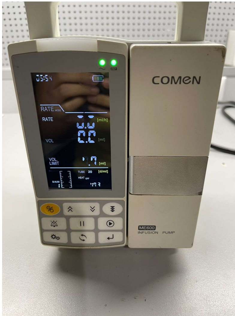
Ilustración 21. Falla parcial en la pantalla de bomba de infusión. Fuente: Elaboración Propia.
