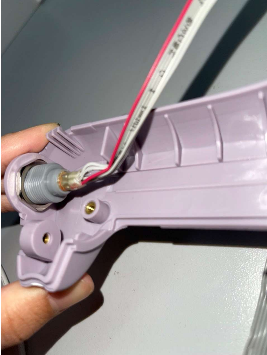
Ilustración 38. Soldado de cable de control de mando.
