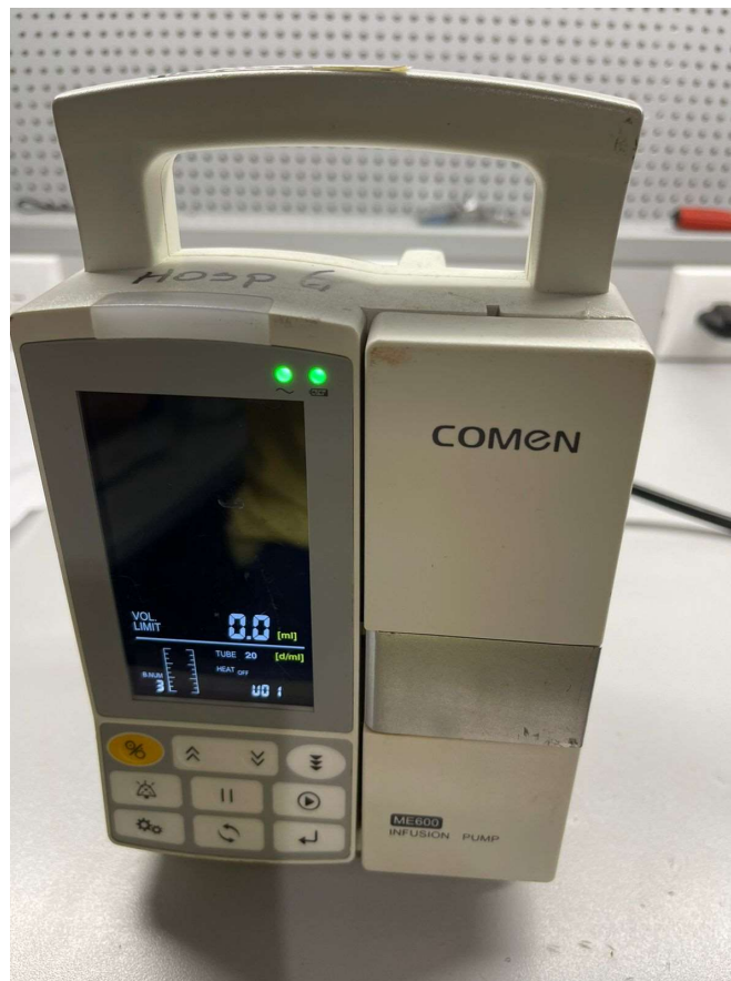
Ilustración 20. Falla en la mitad de pantalla de la bomba de infusión.
