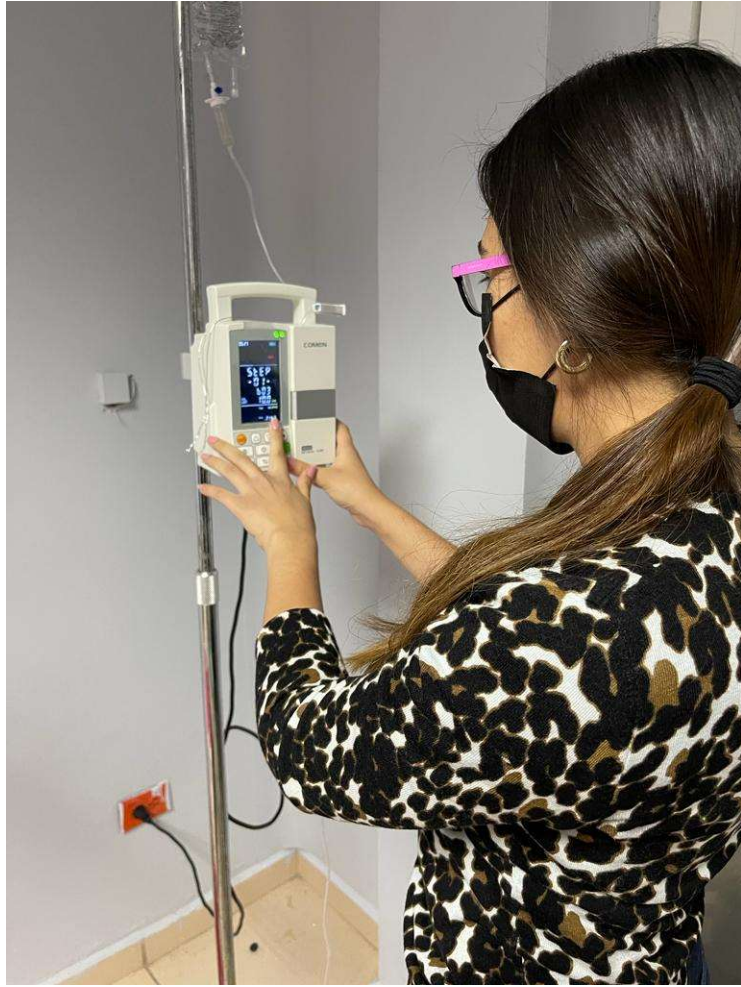
Ilustración 18. Calibración de bomba de infusión. Fuente: Elaboración Propia.
