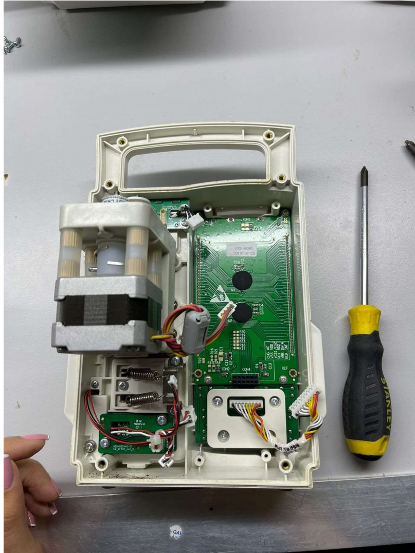
Ilustración 23. Conexión de pantalla nueva en bombas de infusión. Fuente: Elaboración Propia.
