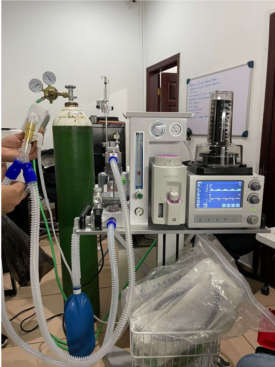
Ilustración 27. Máquina de anestesia veterinaria siendo probada previo a instalación. Fuente: Elaboración Propia.
