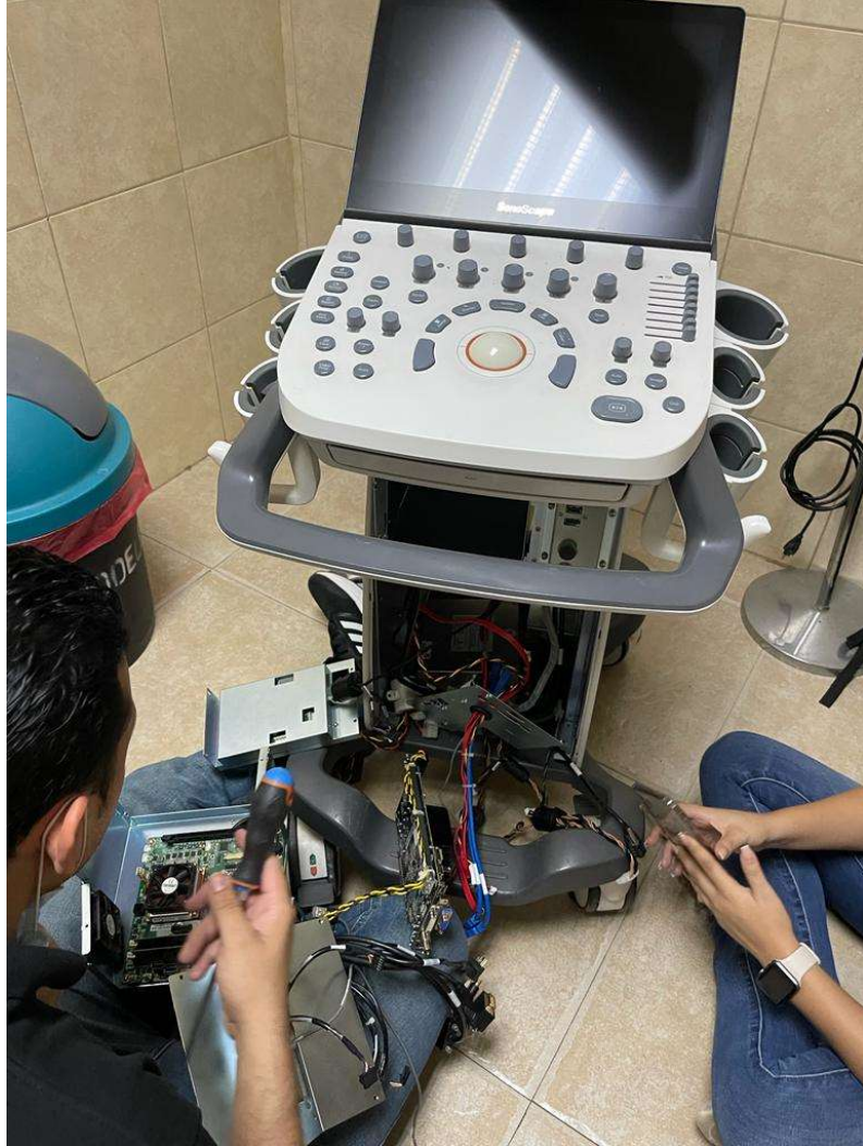
Ilustración 15. Reemplazo de tarjeta en ultrasonido.
