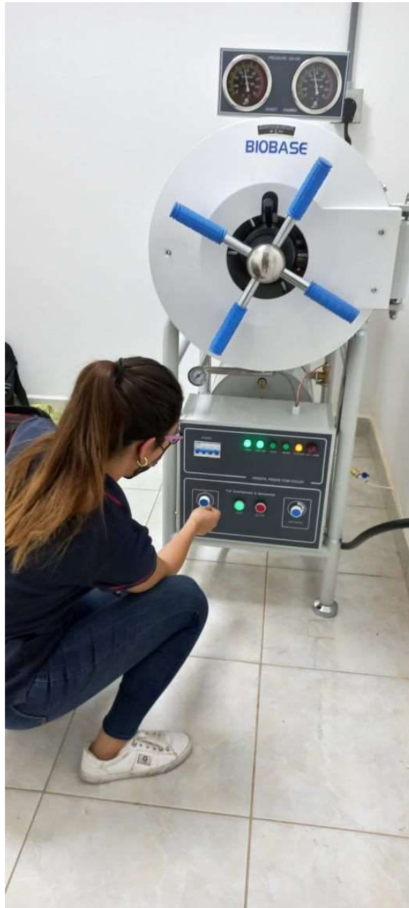
Ilustración 32. Inicio de prueba de funcionamiento de autoclave. Fuente: Elaboración Propia.
