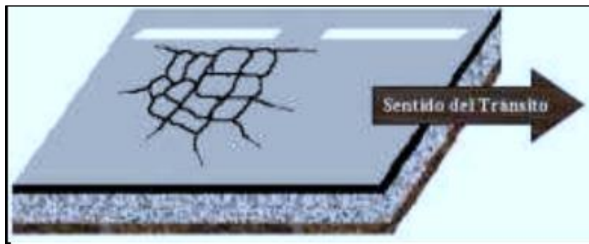
Ilustración 15- Esquema fisura en bloque
