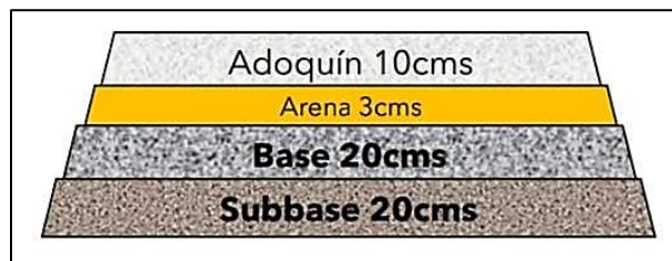
Ilustración 8 - Perfil estructura de pavimento de adoquín
