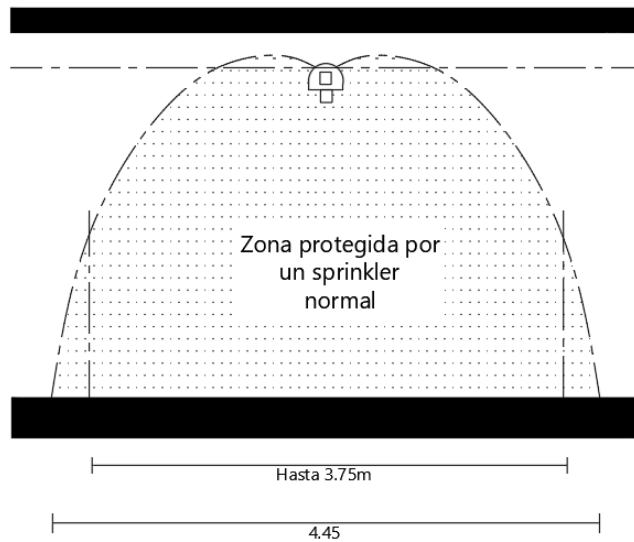
Ilustración 67. Distribución de agua de los sprinklers normales
