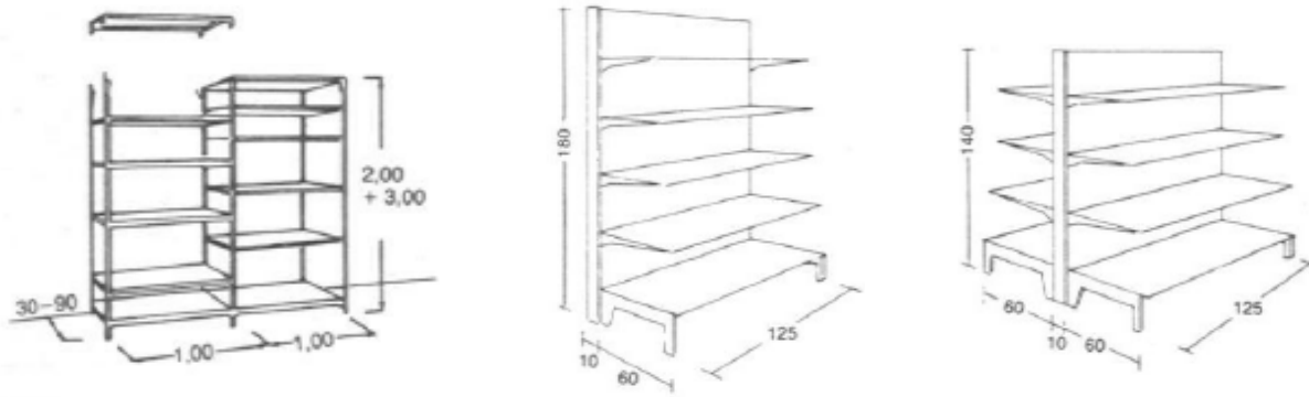
Ilustración 85. Modalidades y dimensiones de estanterías para almacenamiento
