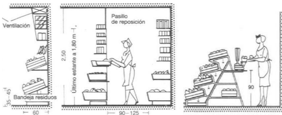
Ilustración 81 Dimensiones de estantería para frutas y verduras
