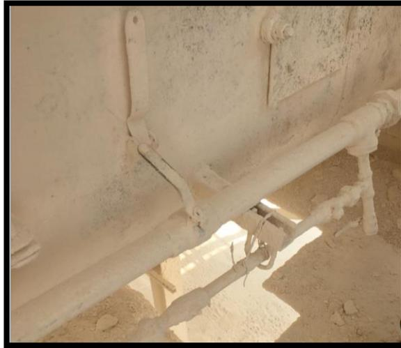
**Ilustración 9 Válvula manual con la que se regula el agua que ingresa a la hidratadora**
