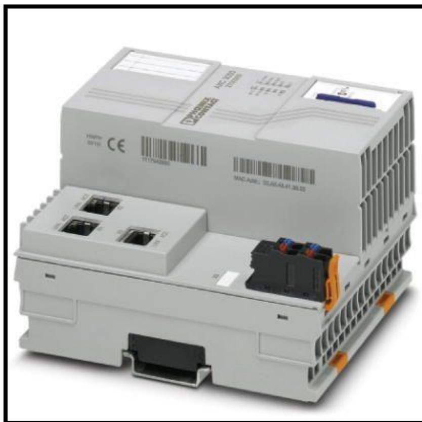
**Ilustración 5 PLC de Phoenix Contact**
