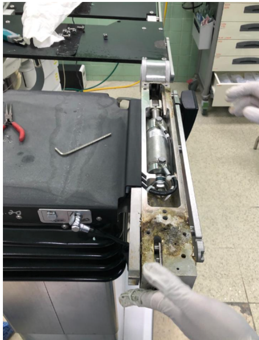
Ilustración 15 - Corrosión de mesas
