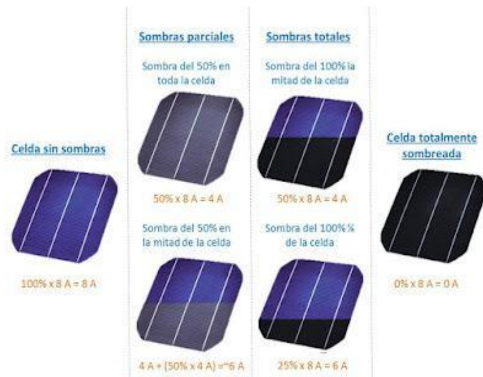
Ilustración 23- Efectos de la sombra en los módulos fotovoltaicos.
