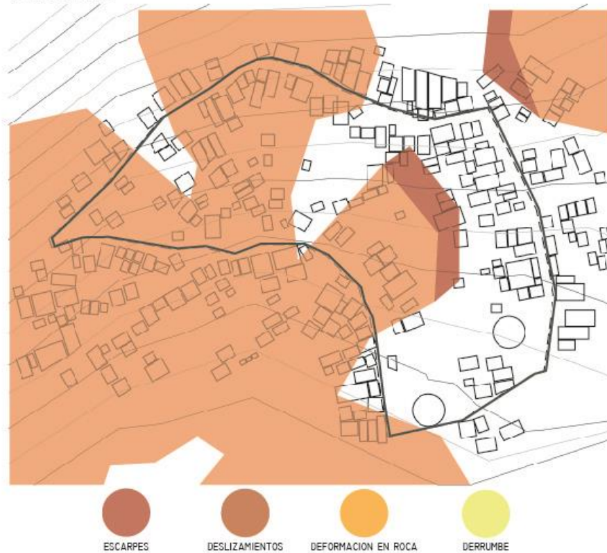
Ilustración 45. Inventario de deslizamientos en la Colonia Guillén, Sector 1.
