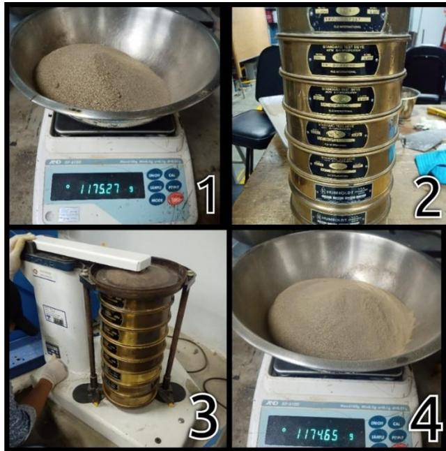
**Ilustración 35. El 26 de marzo 2022, se realizó una prueba de laboratorio "Granulometría".**
