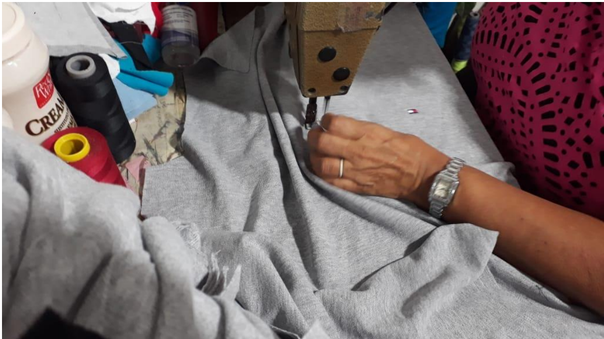
Ilustración 22, cuadro de plaqueta, operación número 4 en el proceso de producción.
