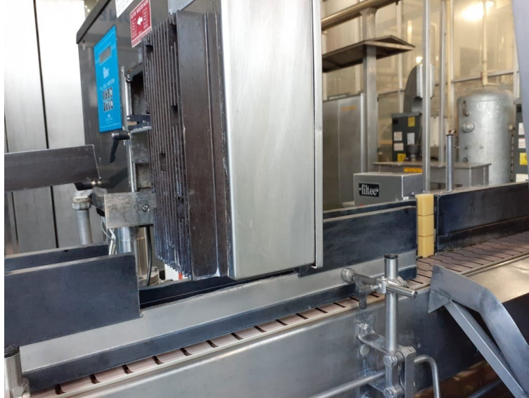
Ilustración 14 - Filtec FT-75 Sensor de Llenado por Rayos-X
