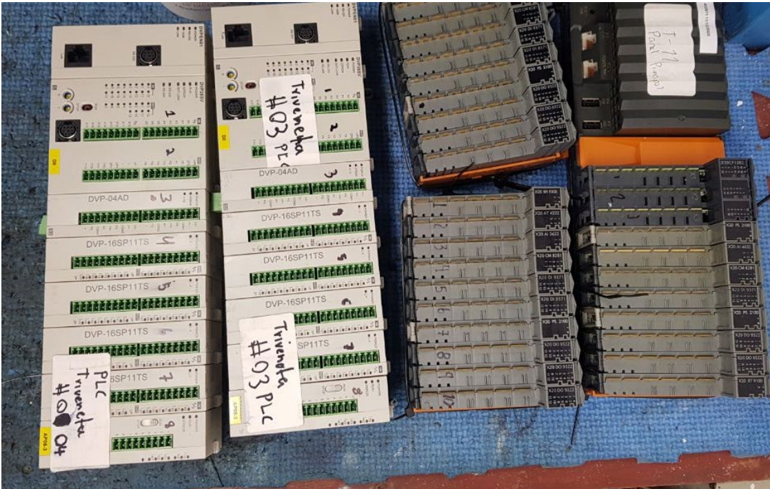
Ilustración 40 - PLC Reparados B&R y Delta
