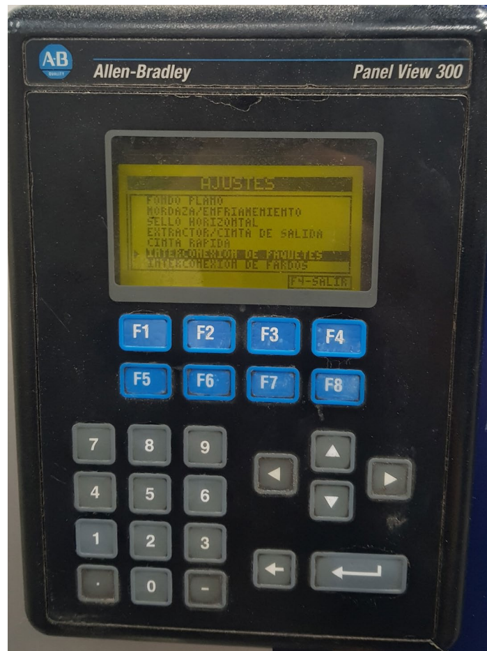
Ilustración 24 - HMI Allen Bradley Panel View 300
