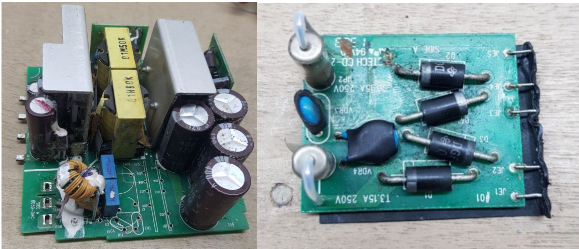
Ilustración 16 - Fuente de Alimentación Reparada para PLC
