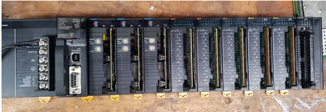
Ilustración 41 - PLC Omron CJ2M
