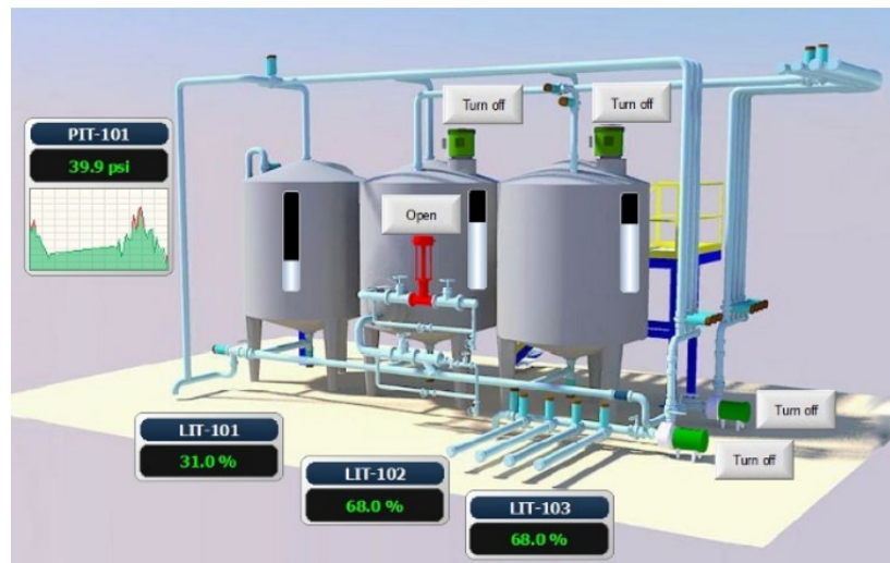
Ilustración 4 - Ejemplo de sistema SCADA
