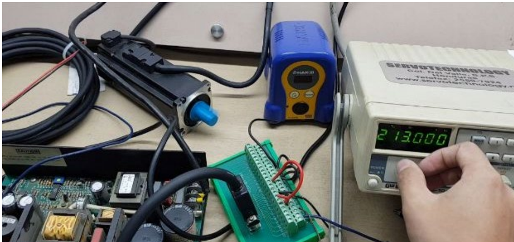
Ilustración 15 - Servomotor Controlado por Tren de Pulsos
