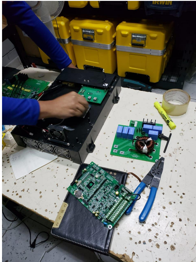
Ilustración 23: Componentes internos de los variadores
