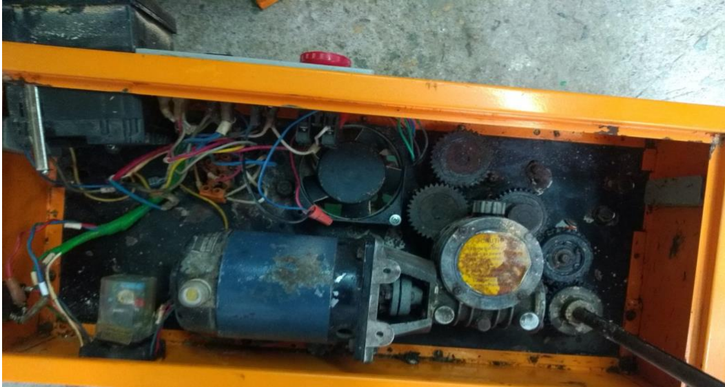
Ilustración 16. Mecanismo Interno Selladora Automática
