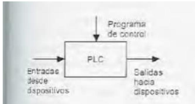
**Ilustración 5. Diagrama de funcionamiento del PLC**
