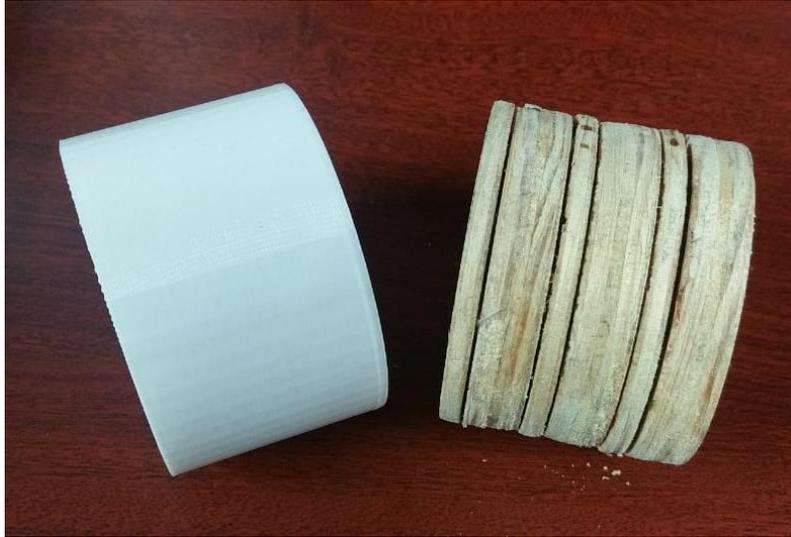
**Ilustración 19. Rodo en madera propuesto, rodo impreso en 3D para instalarlo.**
