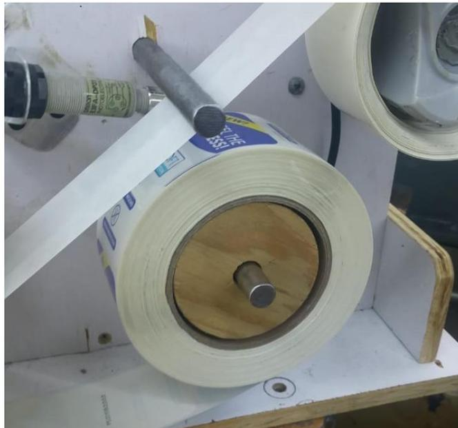
**Ilustración 20. Rodo de madera en pruebas, con resultado exitoso.**
