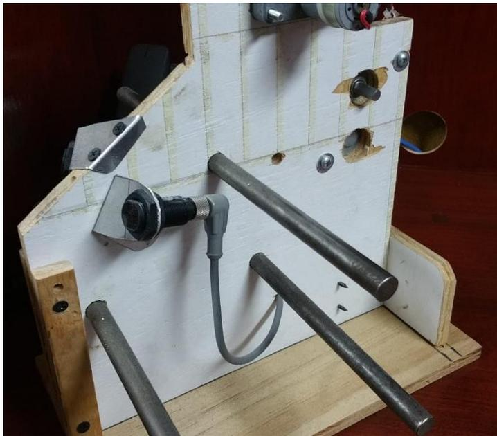
**Ilustración 18. Estructura de dispensador con ejes metálicos.**
