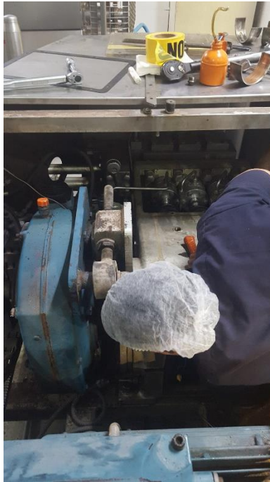
Ilustración 21. Cambio de cigüeñal mantenimiento correctivo.
