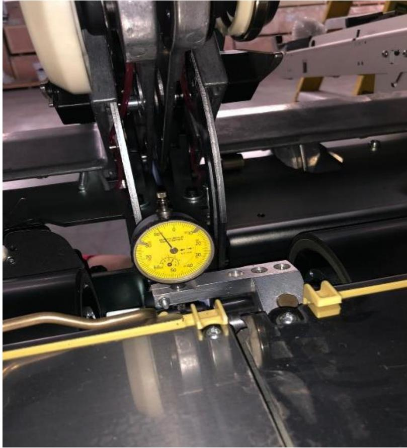
**Ilustración 31-Reloj comparador entre los ejes de la sección**
