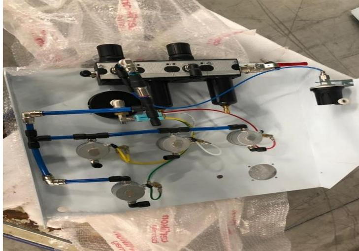
**Ilustración 27-Distribuidor de aire comprimido**
