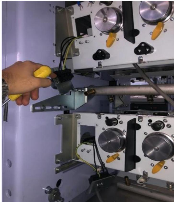
**Ilustración 19-Conexión de motores trifásicos**
