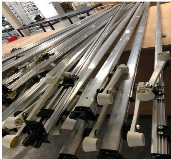
**Ilustración 28-Strings up ya armados previo a su montaje**
