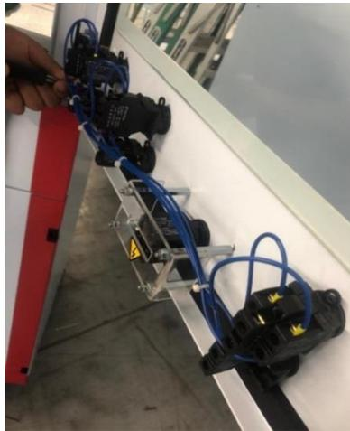
**Ilustración 18-Conexión de las botoneras de la computadora.**
