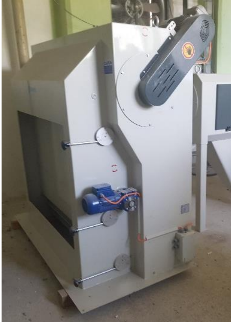
Ilustración 10 - Tarara con succión de aire
