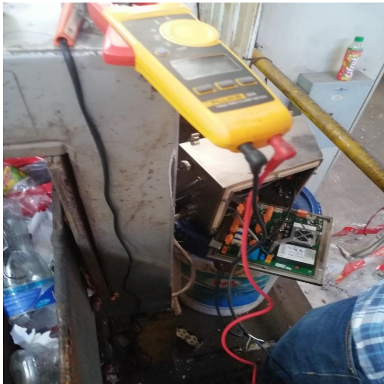
Ilustración 18. Detección de líneas de interconexión en detector de metales
