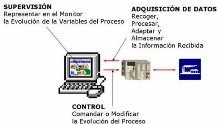
**Ilustración 22. Funciones de un sistema SCADA**
