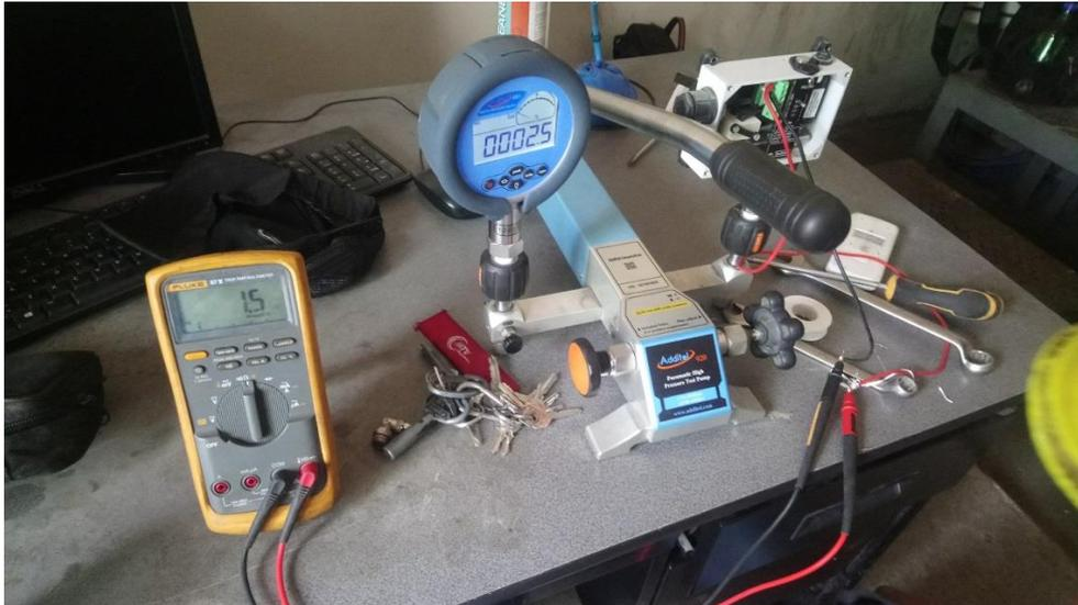
**Ilustración 25. Calibración de switch de presión**
