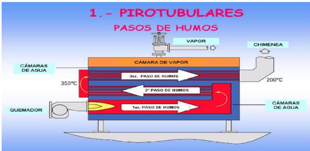
**Ilustración 2. Esquema de caldera piro tubular**
