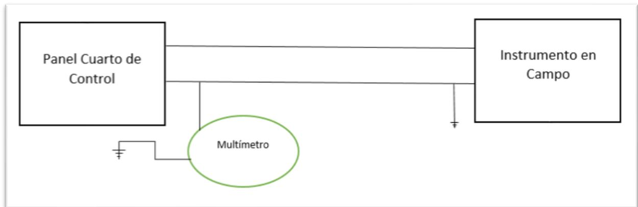
**Ilustración 20. Diagrama de loop checking**
