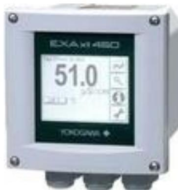
**Ilustración 15. Analizador de conductividad Yokogawa**
