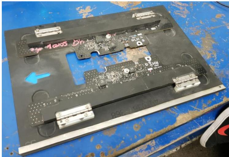
**Ilustración 33 - Modificación con tira metálica en un extremo de placa.**
