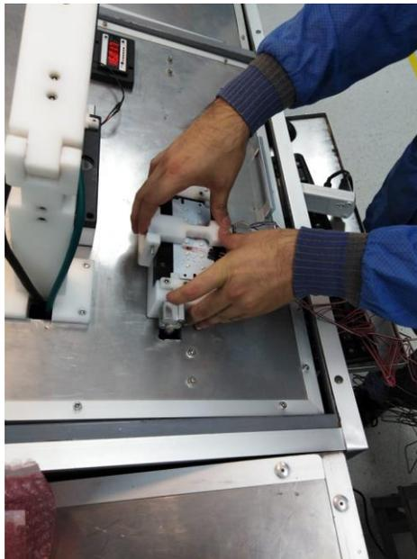
***Ilustración 27 - Prueba de estrés realizada en fixtura para prueba electica.***
