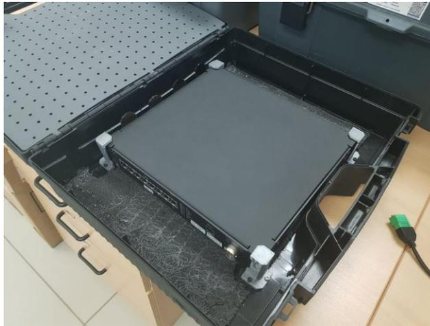
**Ilustración 23 - Montaje de 8000-8-SM de Micro-Measurements en maletín.**
