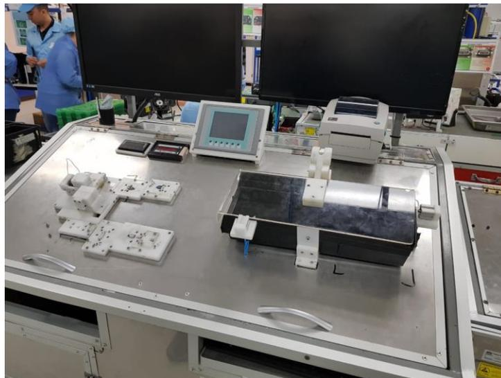
**Ilustración 20 - Prueba funcional de sensor de efecto Hall.**
