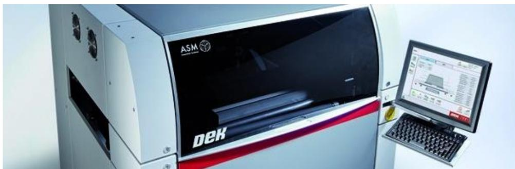
**Ilustración 5: impresora de plantilla modelo DEK NeoHorizon iX.**
