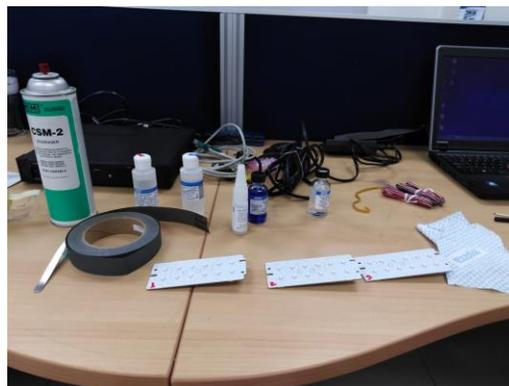
**Ilustración 25 - kit para la fijación de galgas extensiométricas sobre PCB.**
