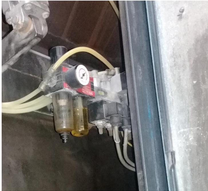
**Ilustración 7. Unidad de Mantenimiento de la maquinaria LAVATEC**
