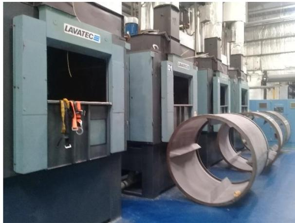
**Ilustración 1. Secadora de prendas marca LAVATEC**
