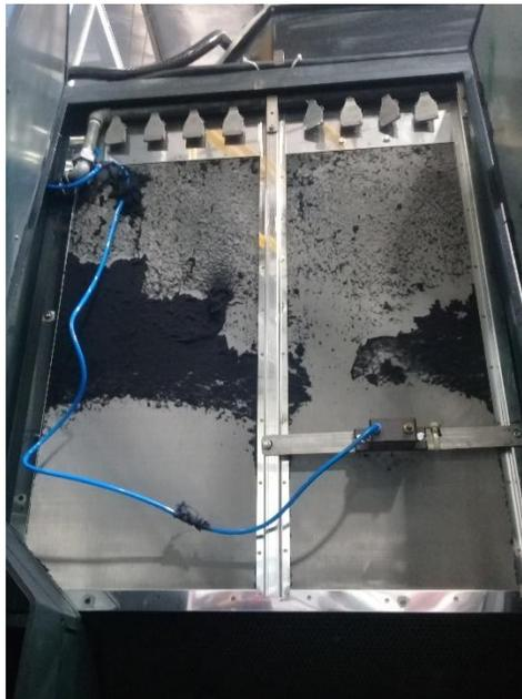
**Ilustración 22. Malla lateral de la secadora LAVATEC**
