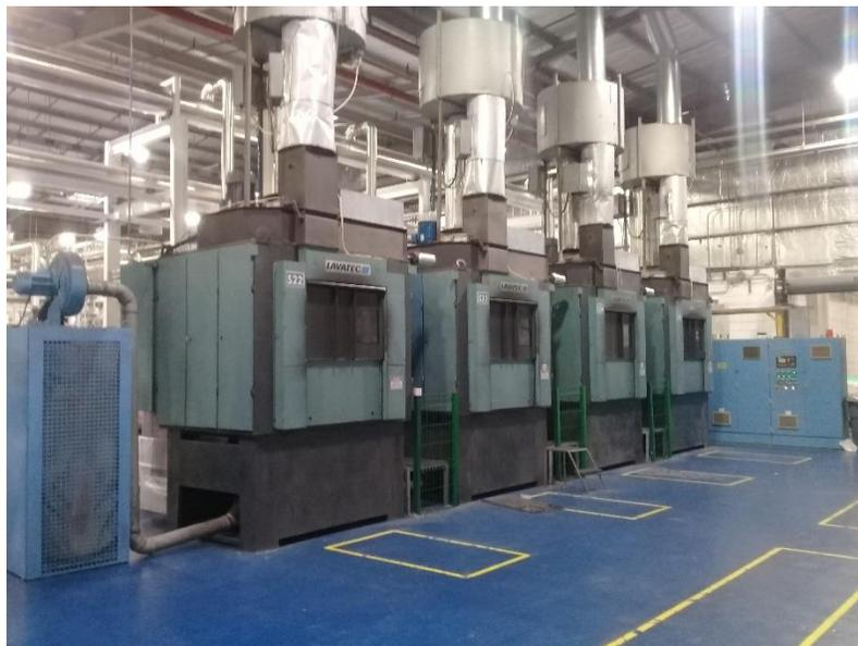
**Ilustración 35. Secadoras Lavatec en el cual se hicieron las modificaciones**
