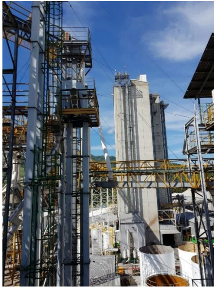
Ilustración 9 Transportador vertical de cangilones, nombrado transportador de Recibo.
