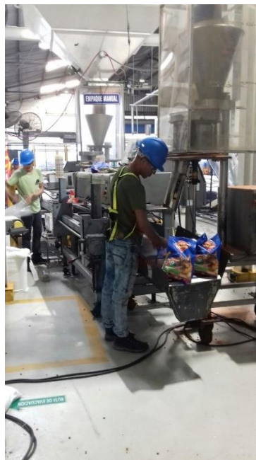
Ilustración 18 Empacadora manual de dogui, parte final del proceso
