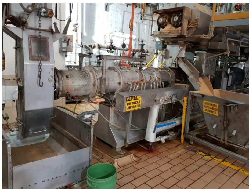
Ilustración 14 Extrusor 8A de planta Extruder, distribuido por Extru-Tech Inc.
