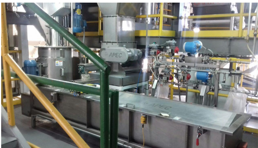
Ilustración 15 Coater automatizado, con tornillos dobles para una mejor mezcla.
