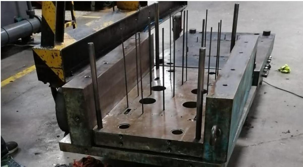
**Ilustración 27. Varillas de molde dañadas**
