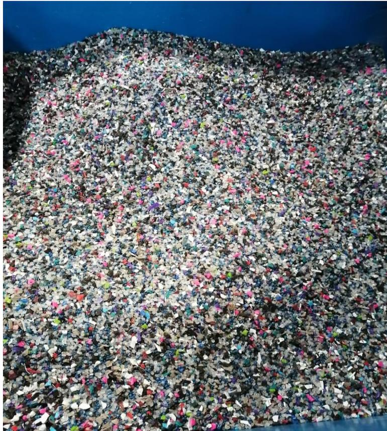
**Ilustración 21. Material molido procesado en Plásticos de Honduras**
