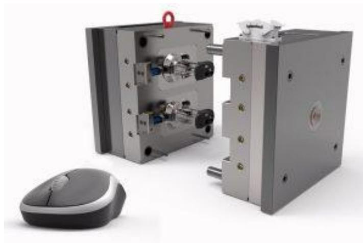
**Ilustración 10. Molde en inyección de plásticos**
