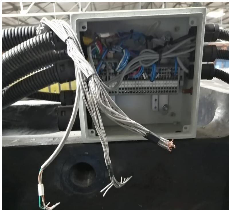
**Ilustración 17. Bloques de terminal utilizados en maquina KL1000**
