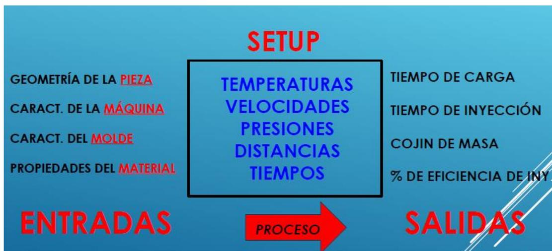
**Ilustración 29. Proceso de ajuste de variables en el moldeo científico**
