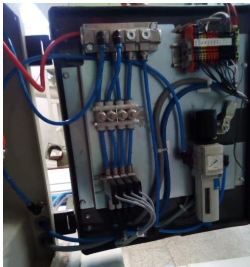
Ilustración 16. Sistema interno de dosificador.
