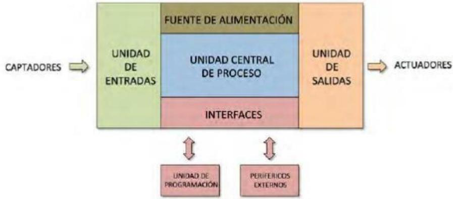
**Ilustración3. Arquitectura básica de un PLC**
