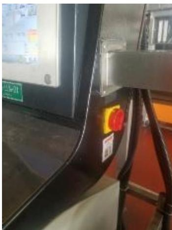
**Ilustración 19 Interruptor para bloqueo de energía eléctrica (llenadora)**
