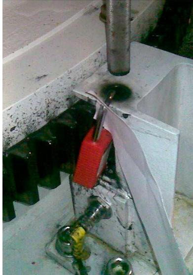
**Ilustración 20 Bloqueo mecánico (llenadora)**
