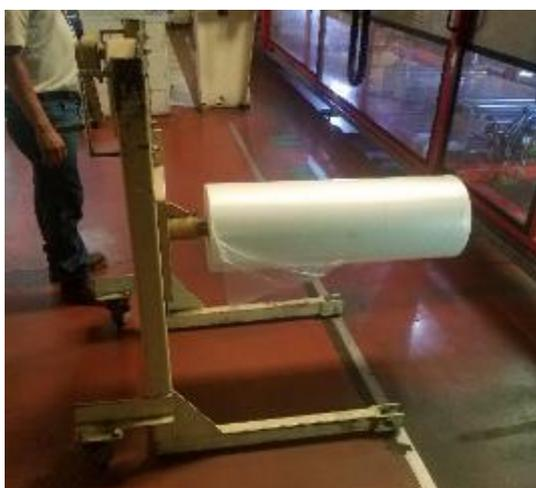
**Ilustración 16 Carro porta Bobinas**
