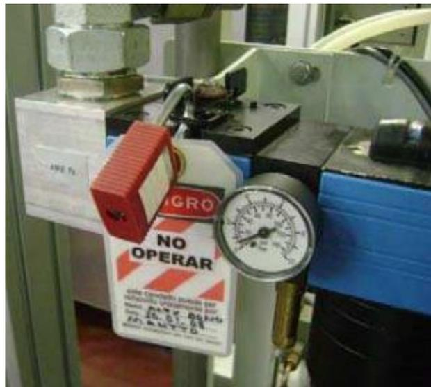
**Ilustración 21 Bloqueo Neumático (paletizadora)**
