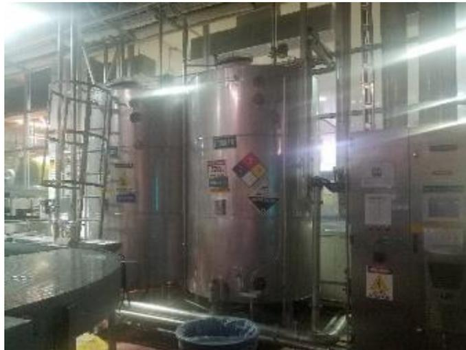
**Ilustración 14 Tanques CIP**
