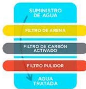
Ilustración 1 Proceso de Tratamiento de Agua
