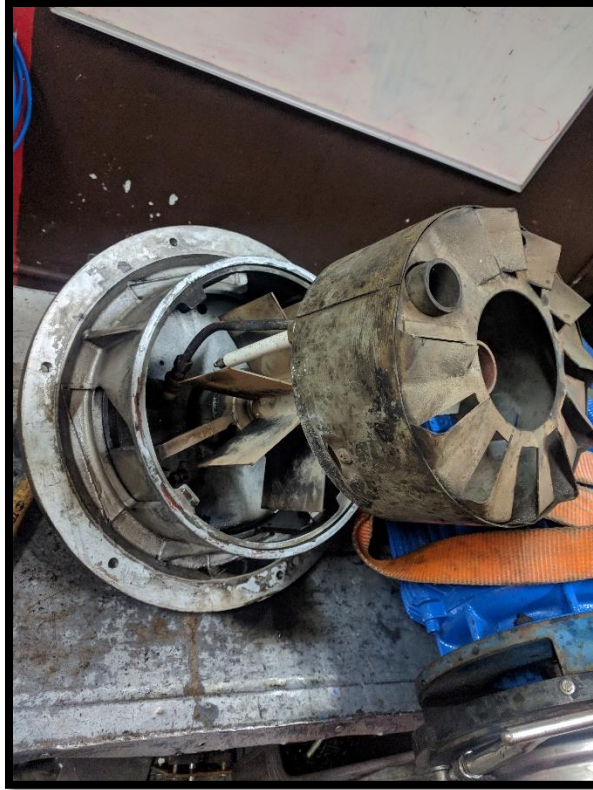
Ilustración 21 Dámper en reparación por sobrecalentamiento
